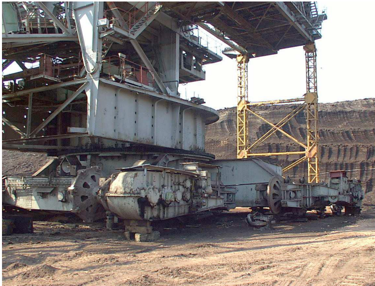
Слика 3. Раскачивање гусеничних ланаца
