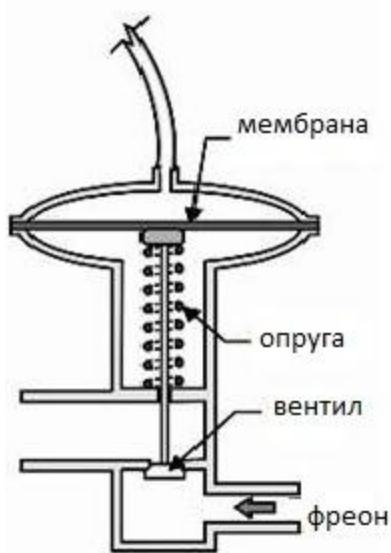
Слика 21. Приказ једног термостатског експанзионог вентила. 9
