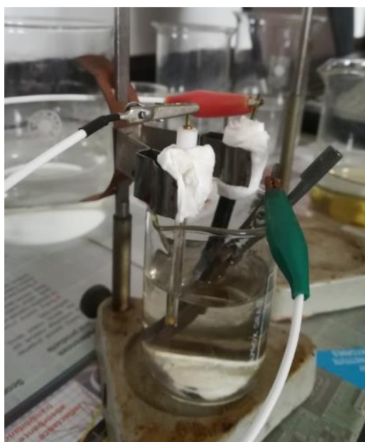
Слика 31. Мерење брзине корозије
