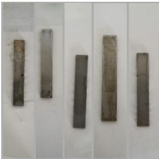
Слика 32. Металне плочице након 30 минута у електролиту, с лева на десно: азотна киселина; борна киселина; пуфер; кишница; натријум-хидроксид
