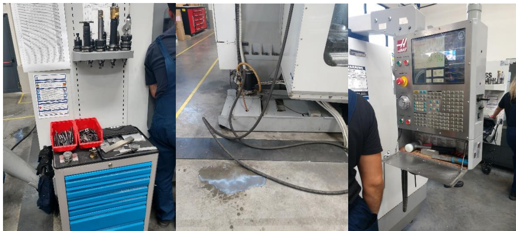
Слика 31. Одлагање ручног алата и алата за машине, контролна табла са одложеним алатом и неправилно вођење рачуна о радном месту
