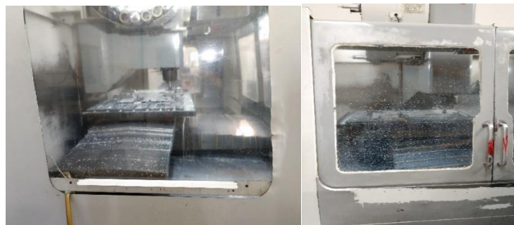
Слика 25. Врата и прозори машине HAAS VF8 које треба дотерати како би нормално функционисала
