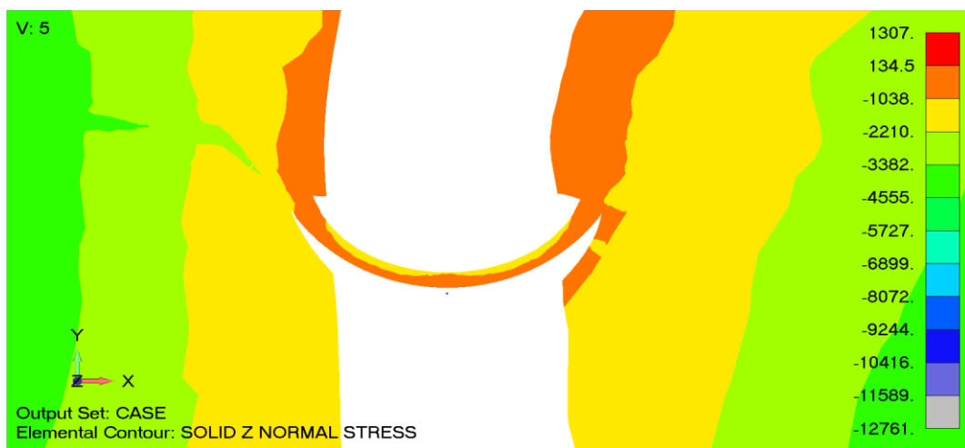
Слика 5.40 Поље вертикалне компоненте напона [kPa] у хоризонталном пресеку на коти 350 mm
