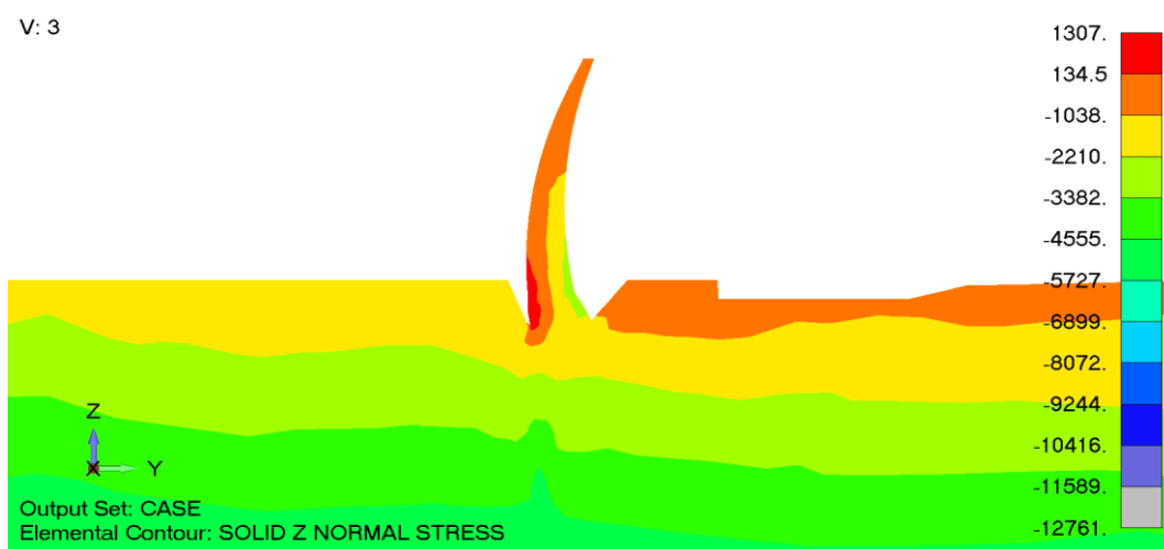
Слика 5.38 Поље вертикалне компоненте напона [kPa] у вертикалном попречном пресеку по оси бране
