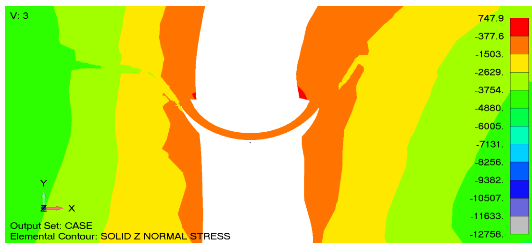
Слика 5.19 Поље вертикалне компоненте напона [kPa] у хоризонталном пресеку на коти 350 mm
