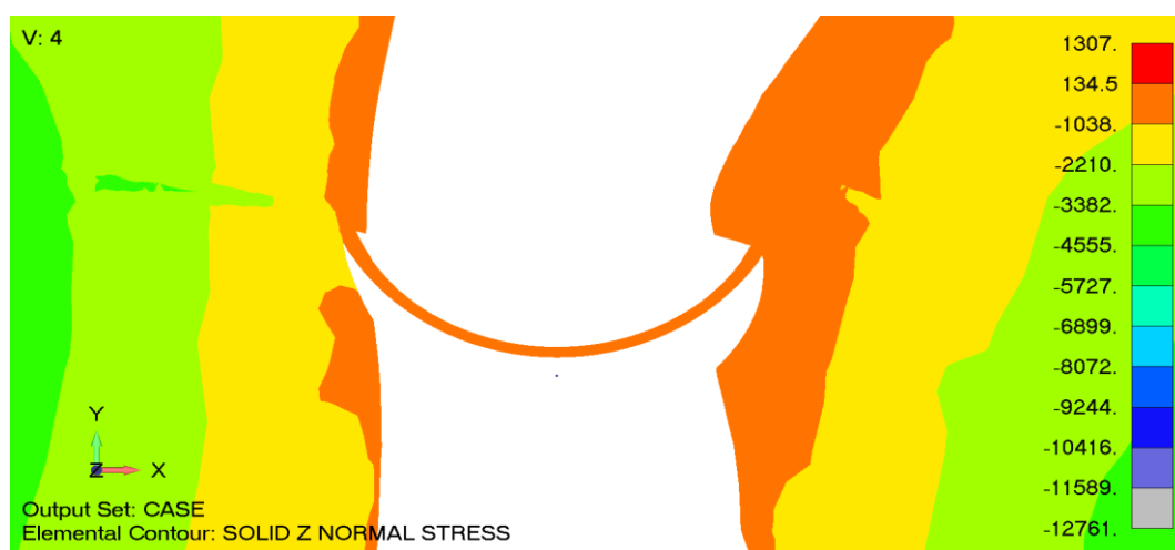
Слика 5.39 Поље вертикалне компоненте напона [kPa] у хоризонталном пресеку на коти 380 mm
