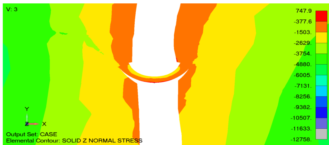
Слика 5.20 Поље вертикалне компоненте напона [kPa] у хоризонталном пресеку на коти 320 mm
