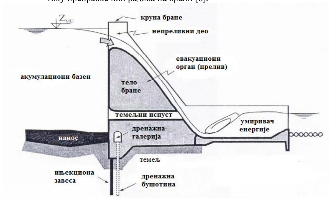
Слика 2.4 Приказ основних елемената бране независно од типа
