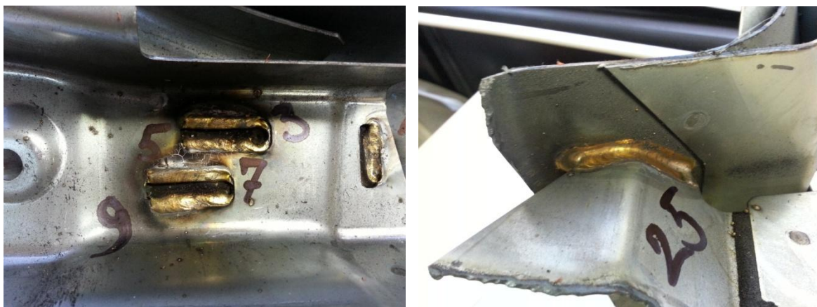
Слика 4.12 Примена МИГ лемљења у аутомобилској индустрији
