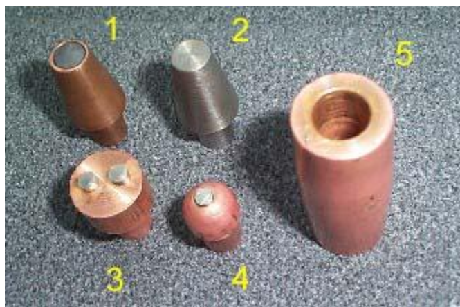
Слика 4.7 Различити облици коришћених електрода: 1 - бакарна електрода са графитним уметком, 2 - електрода од челика \text{C}6880 , 3 и 4 - бакарне електроде са уметцима од волфрама, 5 - бакарни носач доње електроде [7, 8]
