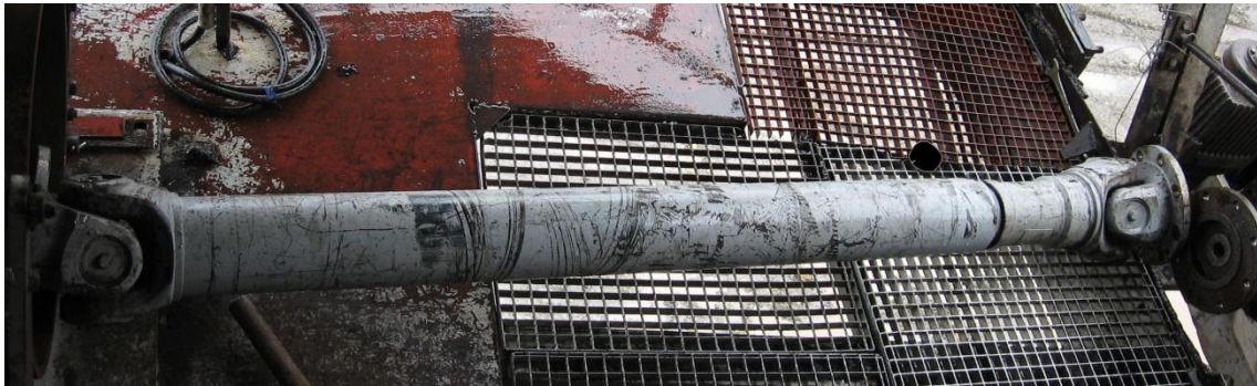
Слика 49. Карданско вратило између ел.мотора и редуктора радног точка
