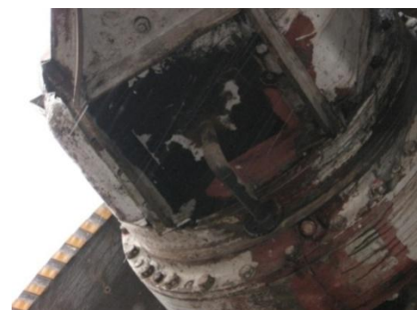
Слика 63. Прикључак за испуштање уља из редуктора копања
