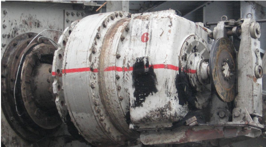
Слика 30. Кочница са плочом на редуктору радног точка
