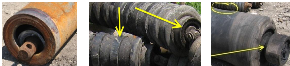
Слика 68-70. Облици оштећења трачних ваљака
