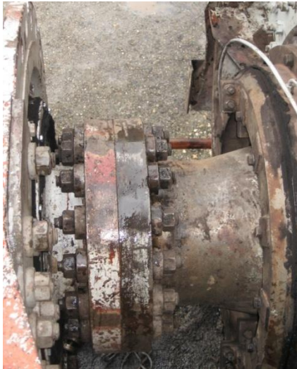
Слика 64. Веза редуктора копања и осовине радног точка
