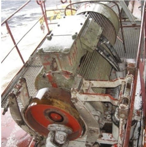
Слика 23. Електромотор погона радног точка
