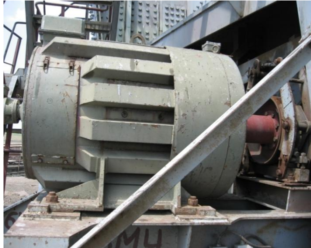
Слика 24. Електромотор обртног механизма претоварне траке
