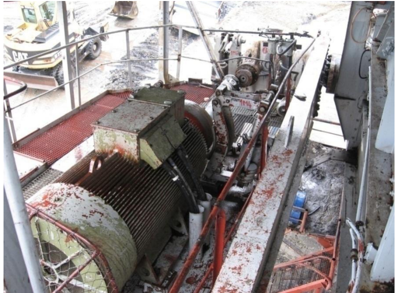
Слика 65. Погон копања са дужим момент трегером
