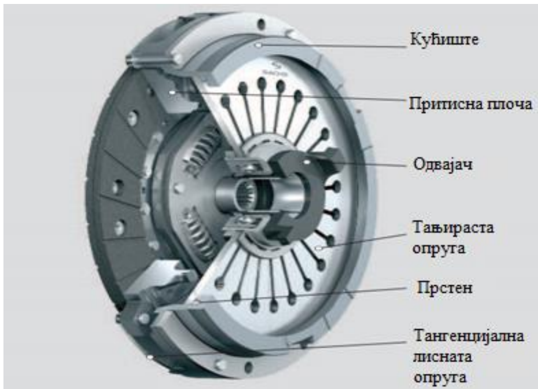
Слика 3.9. Спојница с тањирастом опругом, тип МЗ
