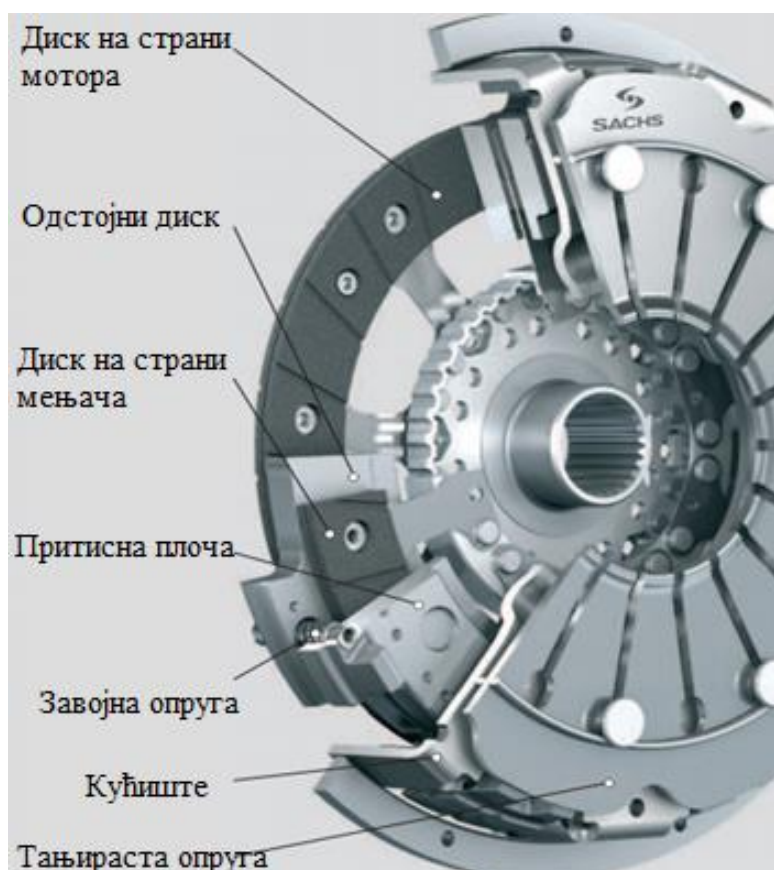
Слика 3.24. Двострука спојница са тањирастом опругом
