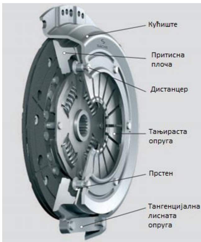
Слика 3.6. Спојница са тањирастом опругом, тип М
