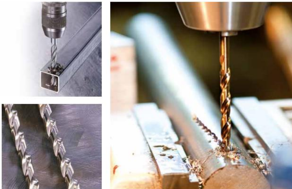
Слика 6. Процес бушења метала [6]
