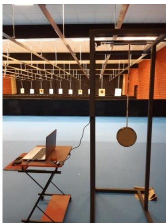
Слика 23. Изглед конструкције балистичког клатна повезаног са рачунаром
