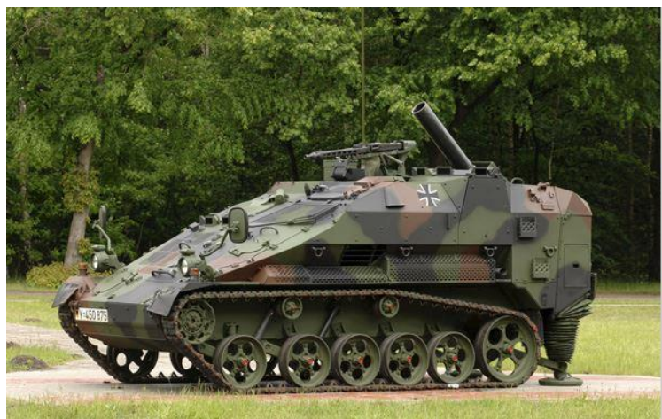
Слика 14 : The Leichter Panzer Morser 120 mm - немачки минобацач, заснован на Wiesel 2 [11]
