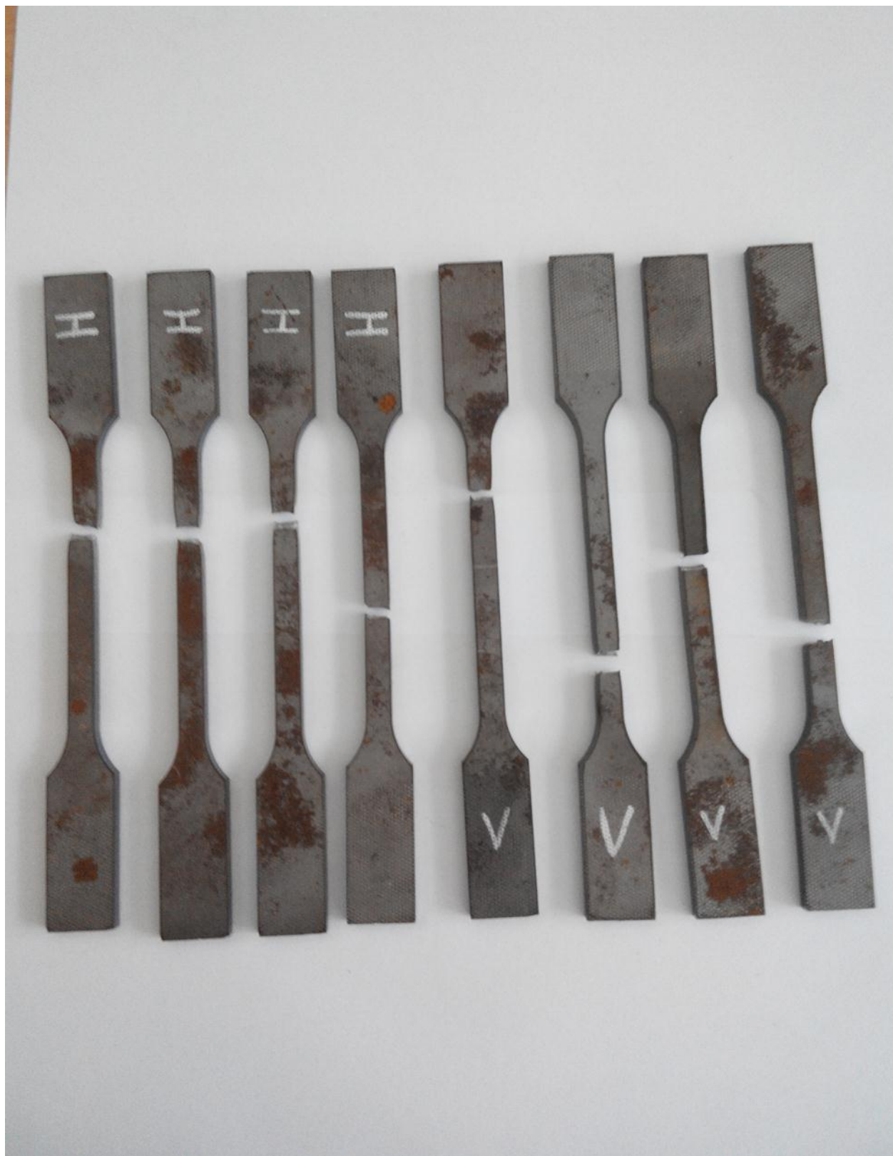
Слика 51. Епрувете након извршеног статичког испитивања
