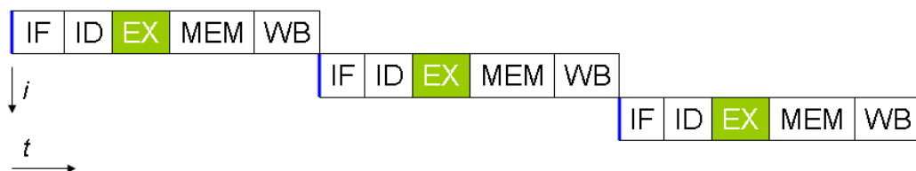
Слика 1. Рад једноставног процесора без pipelininga [7]
