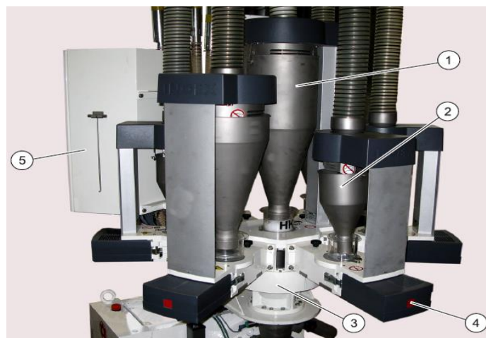
Слика 3.12. Систем дозирања 1- главни левак за дозирање, 2- помоћни левак за дозирање, 3- комора за мешање, 4- пужни систем дозирања, 5- разводни орман; [7]
