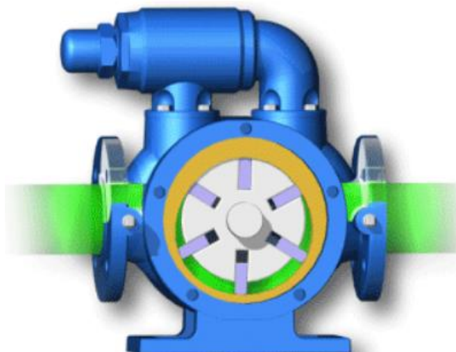
Слика 11 – крилна пумпа са ротором ексцентрично постављеним у односу на статорски прстен
