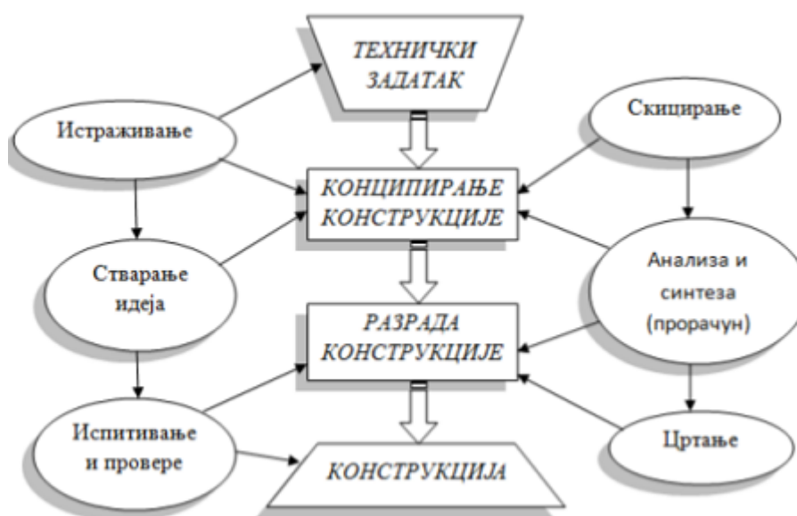
Слика 3.1 Блок дијаграм процеса конструисања
