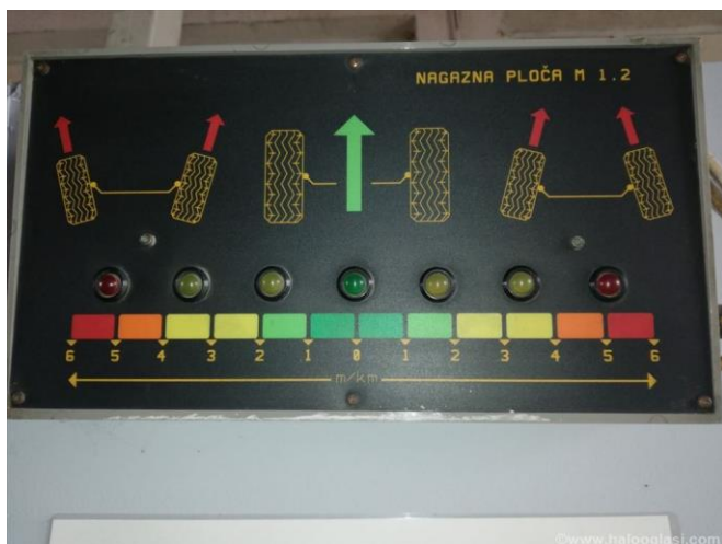
инструмент табле са скалом и казаљком за читавање вредности усмерености предњих точкова. Контрола се врши тако што се возило усмери брзином од 3 – 5 m/s на нагазну плочу и на 1 - 2 m испред плоче пусти (ослободи) точак управљача и возило пређе преко плоче.
