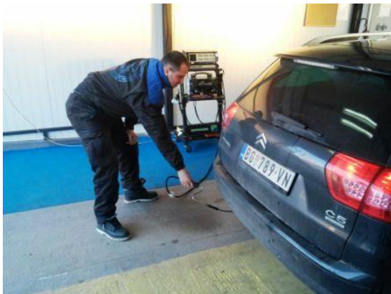
Слика 25: Постављање сонде мерног уређаја у издувну цев
