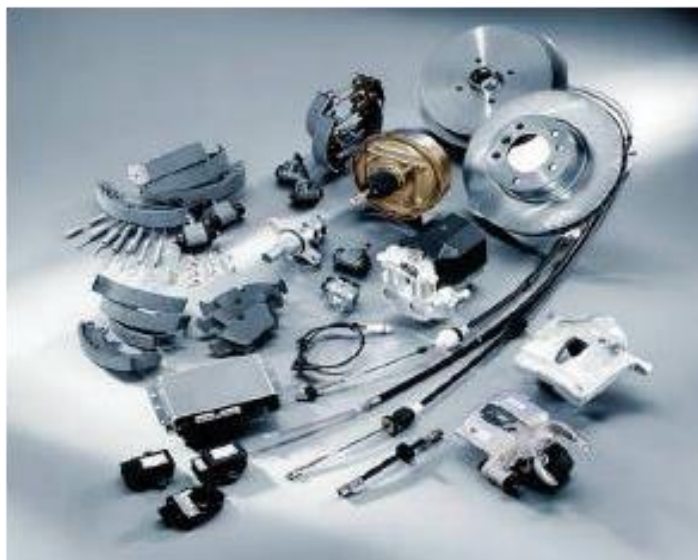
Слика 12 Разни делови израђени од хибридног композита [3]
