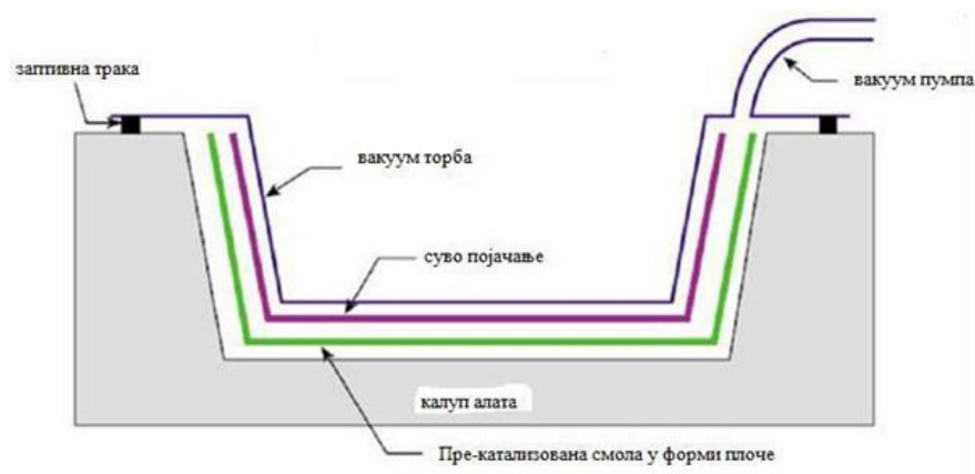
Слика 22 Приказ поступака инфузије слоја смоле [3]
