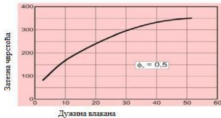
Слика 9 Однос затезне чврстоће и дужине влакана (епоксидна матрица са 50% E стаклених влакана) [2]
