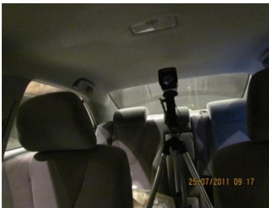
Слика28 - IR камера за мерење температуре са задње стране кабине [5]
