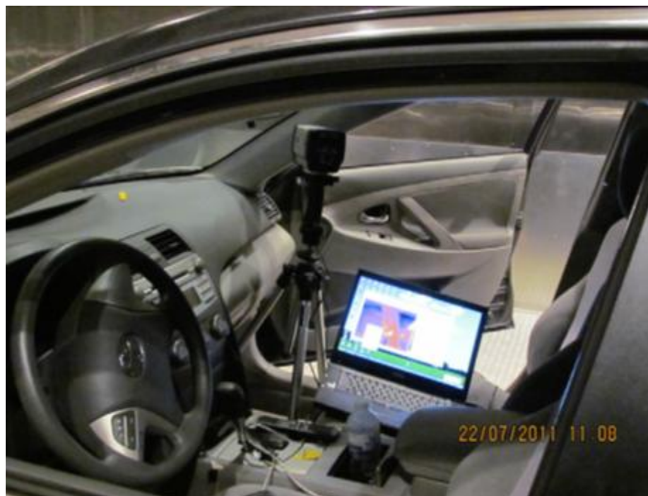
Слика 27- IR камера за мерење температуре лица возача [5]
