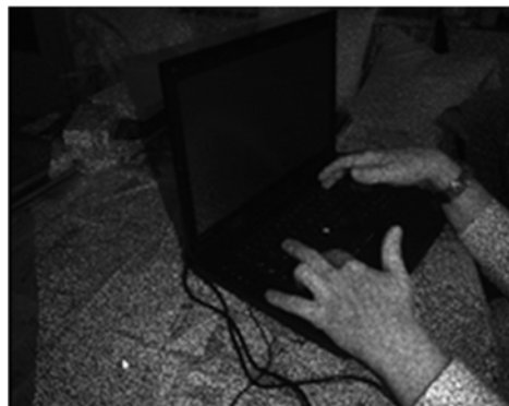
Слика 2-7 Инфрацрвена слика показује ласерску мрежу коју уређај користи да израчуна дубину
