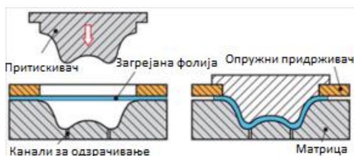
Слика 2.9 Алт за дубоко вучење са матрицом (термообликовање)
