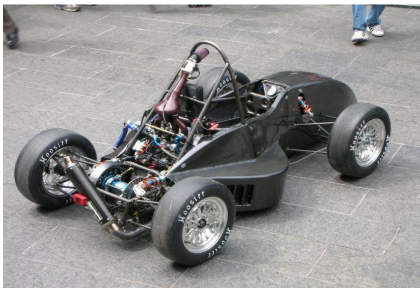
Слика 6. Усисник позициониран изнад главе возача [2]
