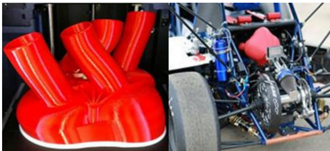
Слика 31. Изглед 3Д штампаног модела и његов положај у склопу формуле [4]
