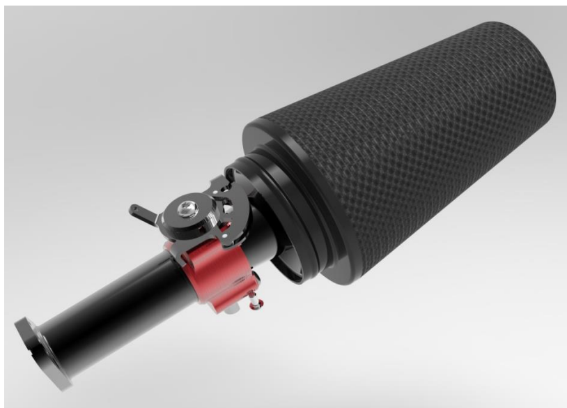
Слика 14. Склоп рестриктора са TPS сензором и филтрера
