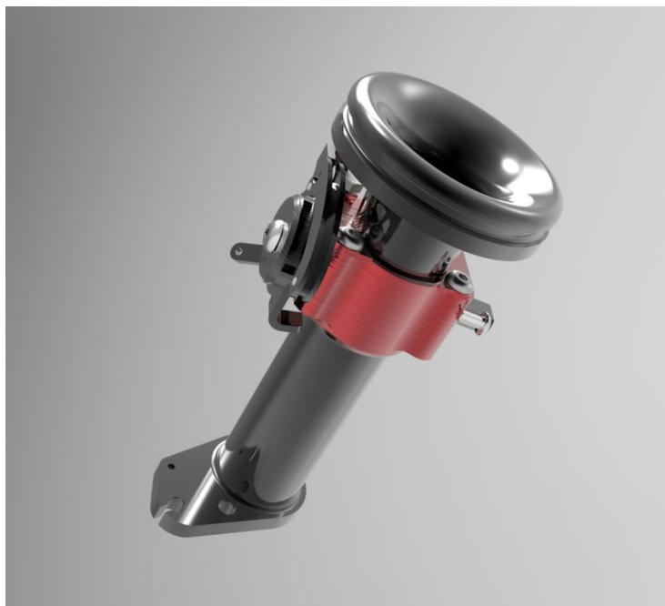
Слика 8. 3D модел рестриктора AT Power
