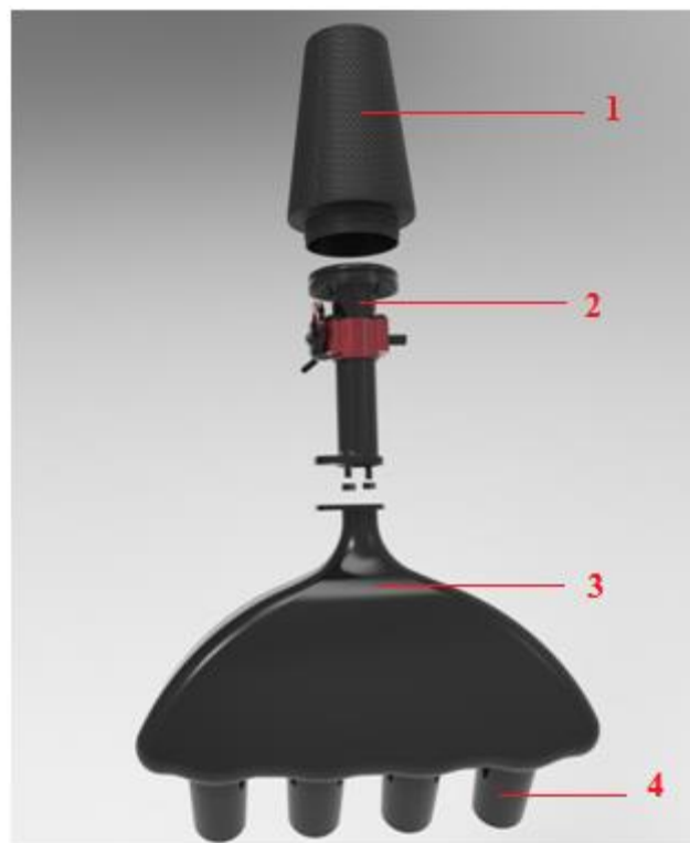
Слика 13. Прва верзија усисног система студентске формуле 1 – филтер за ваздух; 2 – рестриктор са TPS сензором 3 – тело усиса; 4 – разводници
