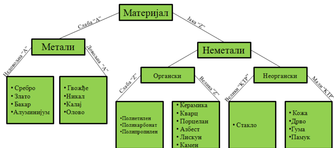
Слика 2.7. Утицај врсте материјала на апсорпцију, термичку проводност и запаљивост [3]
