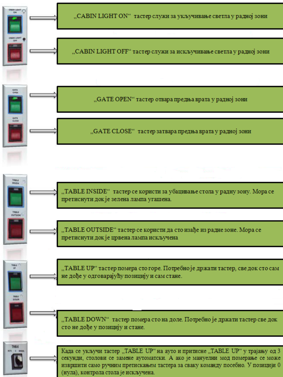
Слика 4.7-б Приказ команди контролне табле за управљање машином [6]
