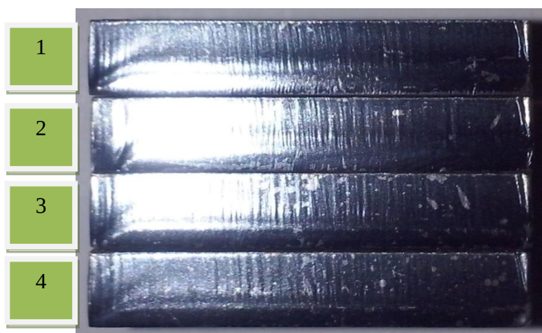
Слика 7.3.6. Плочице исечене под различитим параметрима снаге [5]
