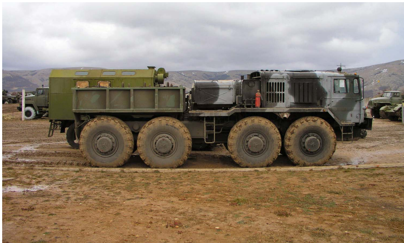
Слика 24: Четвороосовинско специјално возило високе проходности, МАЗ 537" [11]
