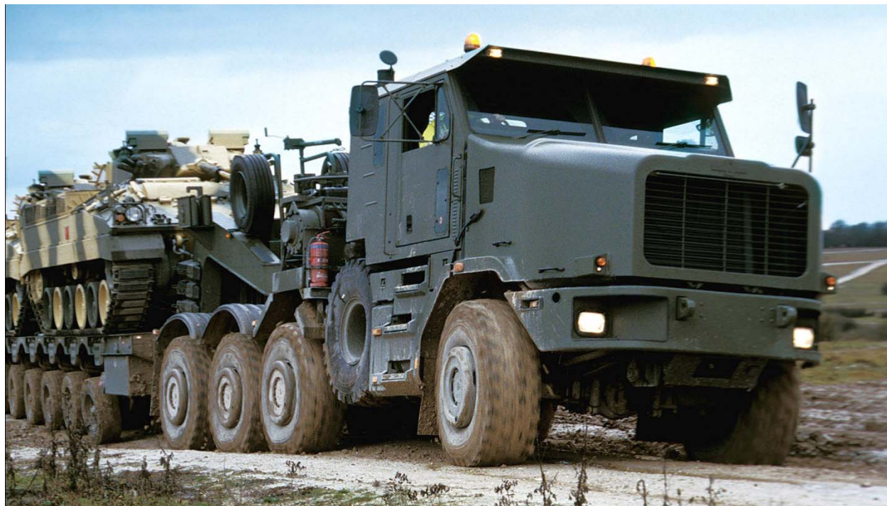
Слика 24: Четвороосовинско возило високе проходности, "Oshkosh M1070" [10]
