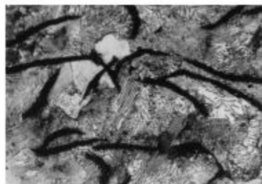
Слика 4.1 Изглед графитне ламеле у сивом ливеном гвожђу (а) и микроструктура перлитног сивог ливеног гвожђа (б)
