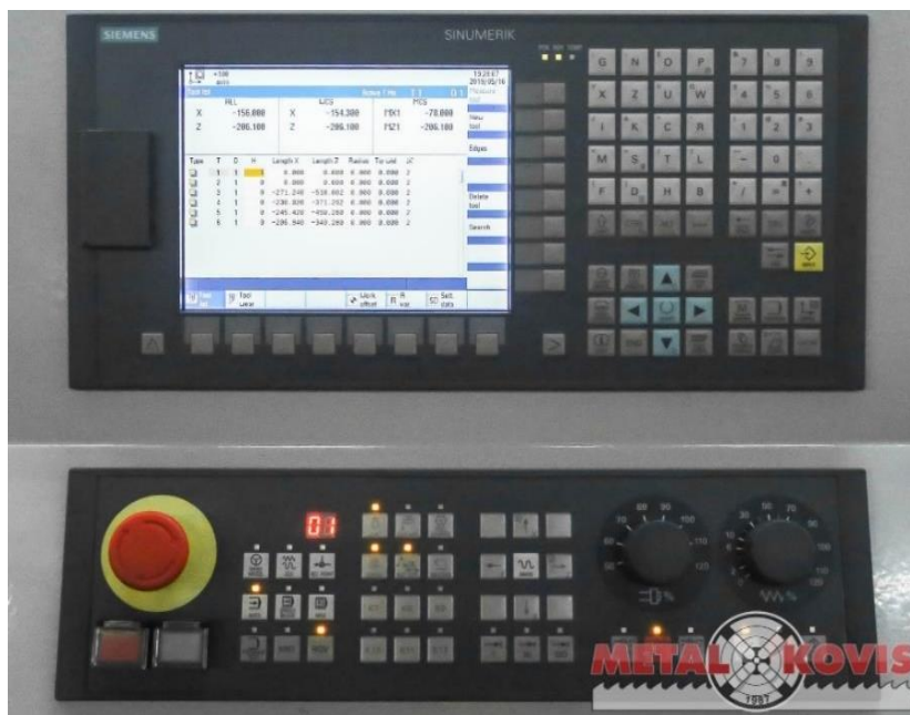
Слика 14 Управљачка јединица (Siemens SINUMERIK 808D) [13]
