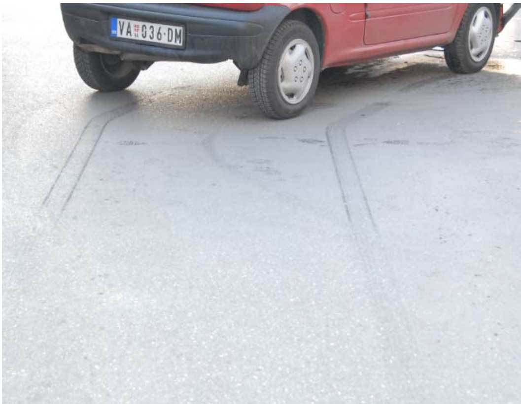
Слика 24: Нагло скретање трага кочења настало у тренутку судара [3]
