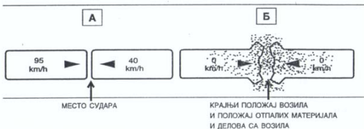
Слика 34: На основу отпалих делова и материјала са возила саобраћајно-технички вештак може приближно одредити место судара и сударне брзине [2]
