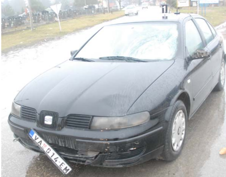
Слика 38: На основу оштећења возила при судару са пешаком, вештак може одредити правац, смер и начин кретања пешака [3]
