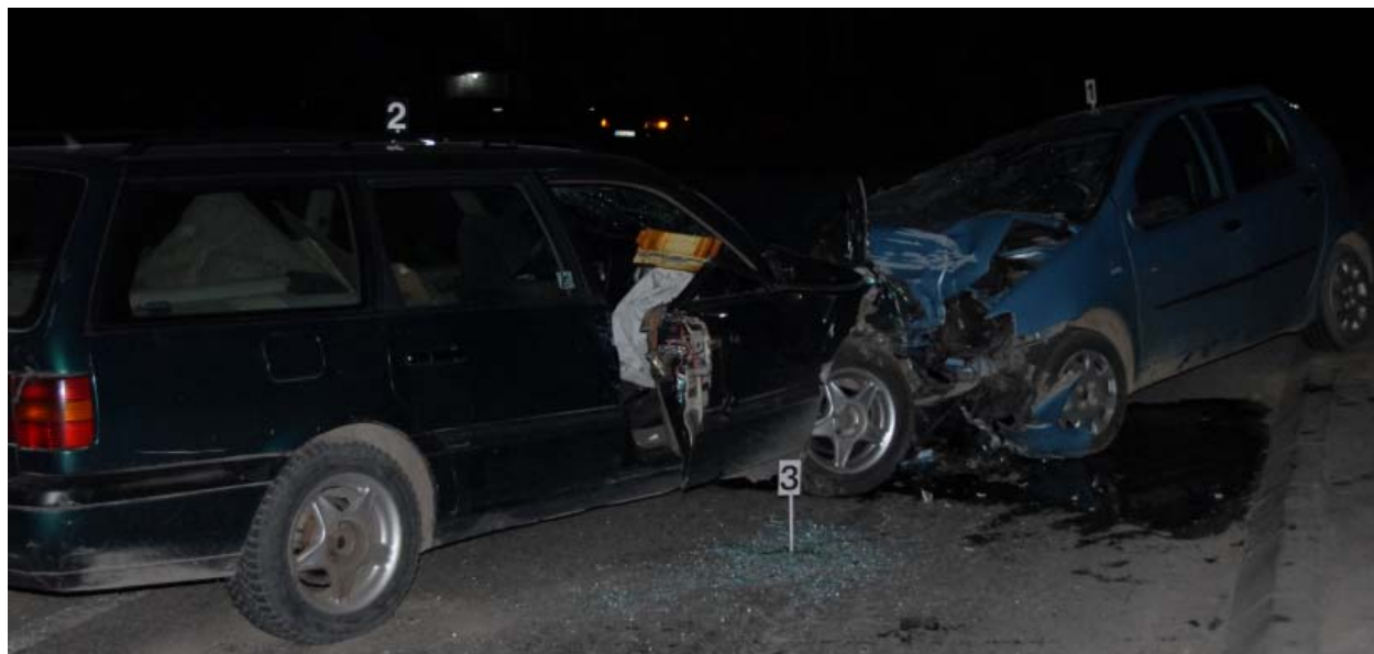
Слика 36: На основу детаљне и упоредне анализе трагова и предмета на лицу места, оштећења затечених возила и објеката и оштећења осумњиченог возила, вештак може поуздано извршити идентификацију НН-возила [3]
