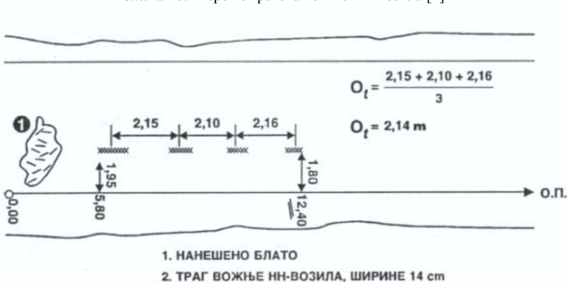
Слика 19: Одређивање обима точка на основу мерења трага вожње НН возила [2]
