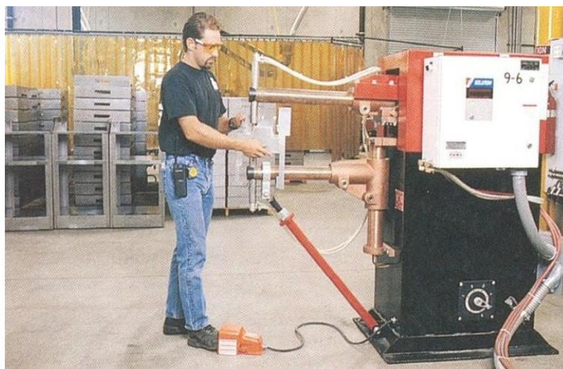
Слика 7.2 Апарат за тачкасто заваривање алуминијума
