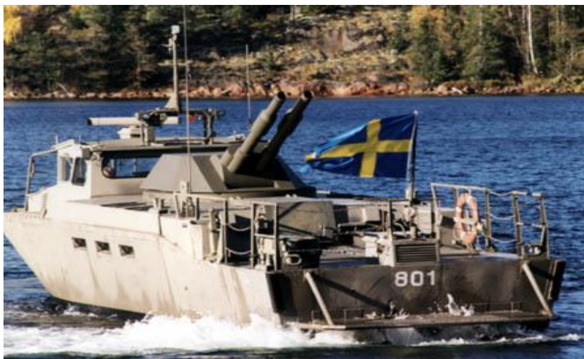
Слика 11. Решење двоцевног минобацача Шведске војске [4]
