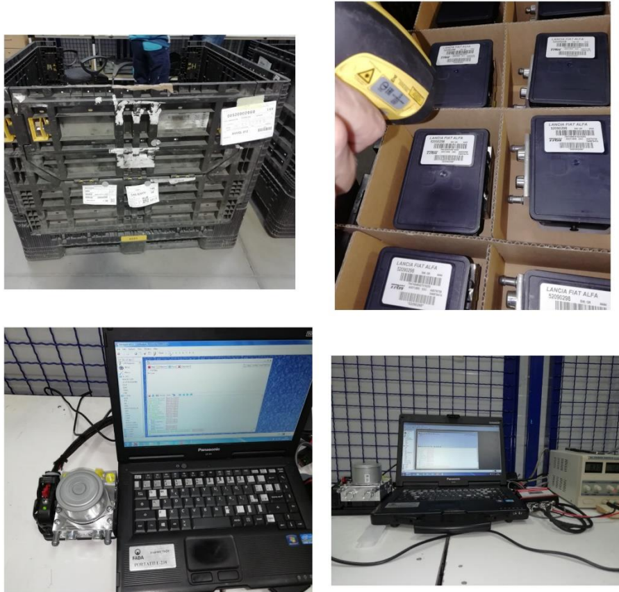
Слика 10. Почетна операција контроле АБС централине
