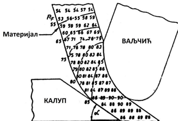
Слика 20. Промена тврдоће у материјалу за време ротационог извлачења са променом дебљине зида[4]
