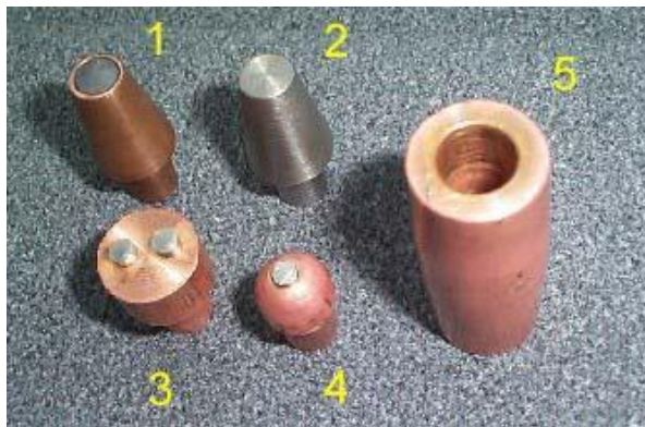
Слика 4.7 Различити облици коришћених електрода: 1 - бакарна електрода са графитним уметком, 2 - електрода од челика Š6880, 3 и 4 - бакарне електроде са уметцима од волфрама, 5 - бакарни носач доње електроде
