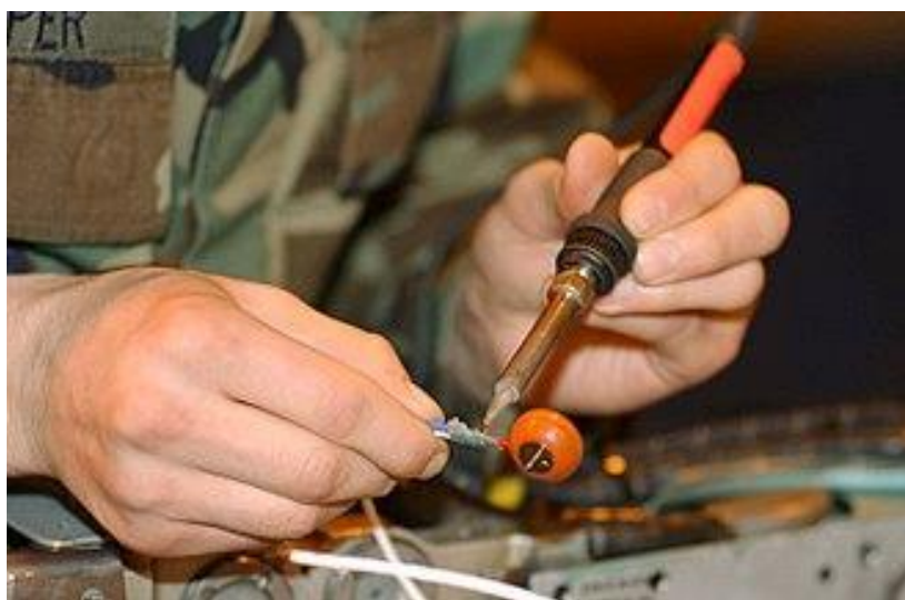
Слика 2.3 Меко лемљење различитих позиција
