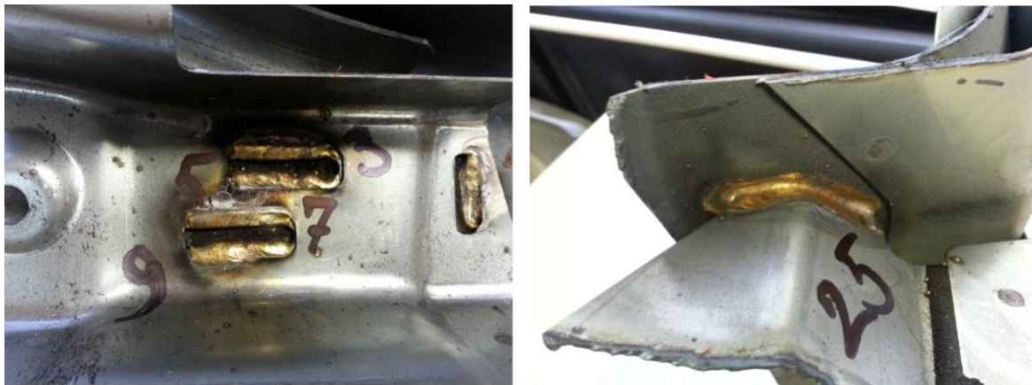
Слика 4.12 Примена МИГ лемљења у аутомобилској индустрији
