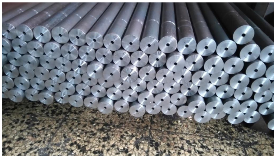
Слика 10.3. Припремице цеви после операције дубоког бушења
