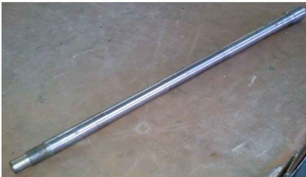
Слика 10.5. Припремак цеви након ожљебљења, спреман за хромирање унутрашње површине
