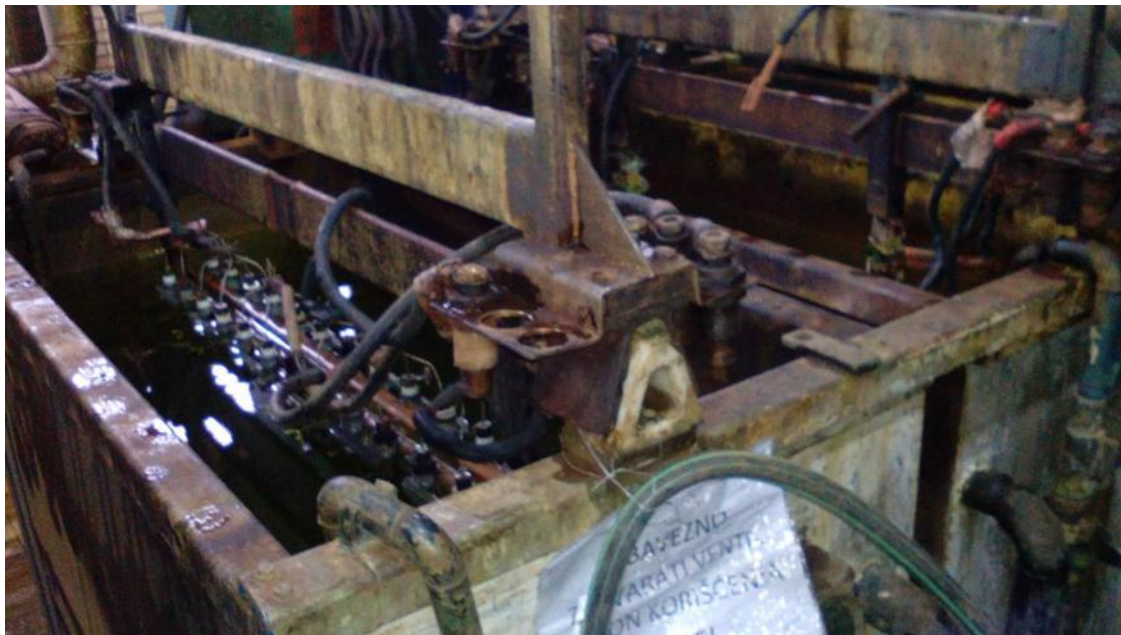
Слика 10.7. Поступак електрохемијског одмашћивања цеви
