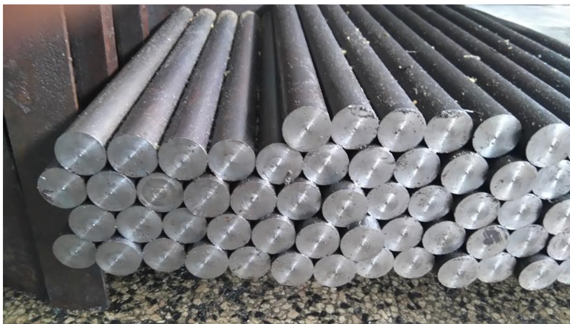
Слика 8.1. Ваљане шипке цилиндричног облика које се користе за производњу цеви кал. 5,56 mm
