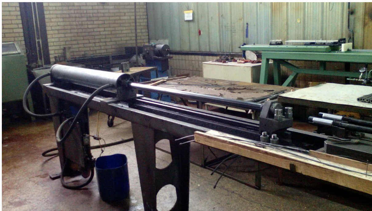
Слика 10.10. Уређај за тесно провлачење водишта пројектила
