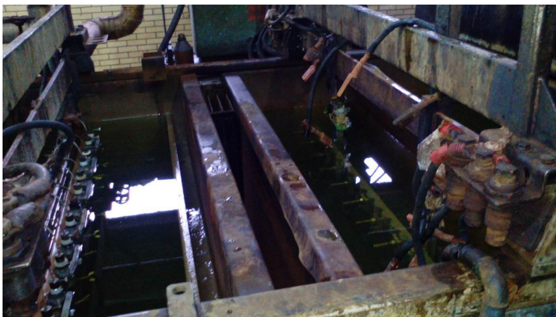
Слика 10.9. Вешалице заједно са припремцима цеви потопљене у електролит за хромирање
