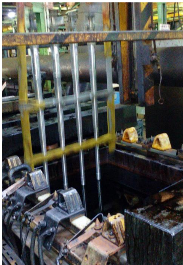
Слика 10.8. Потапање рама са цевима у хроматно – сулфатни електролит
