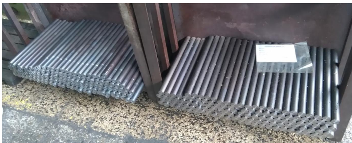
Слика 10.4. Припремице цеви пре операције дубоког бушења – десно, припремице цеви после операције дубоког бушења (лево)
