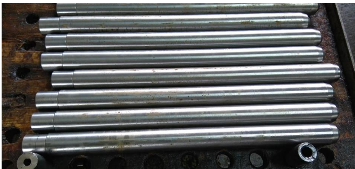
Слика 8.5. Припремци цеви кал. 5,56 mm TW7 за ковање
