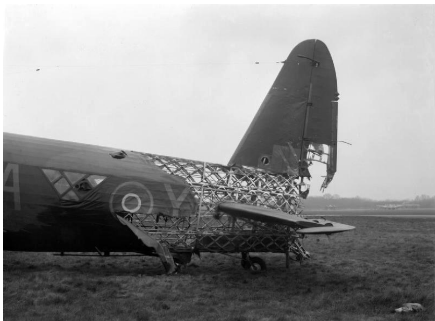
Слика 26. Скелет конструкције трупа летелице оштећеног у борби [19]
