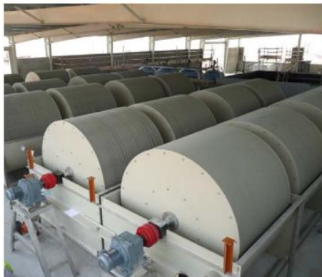
Слика 22. Биодиск систем
