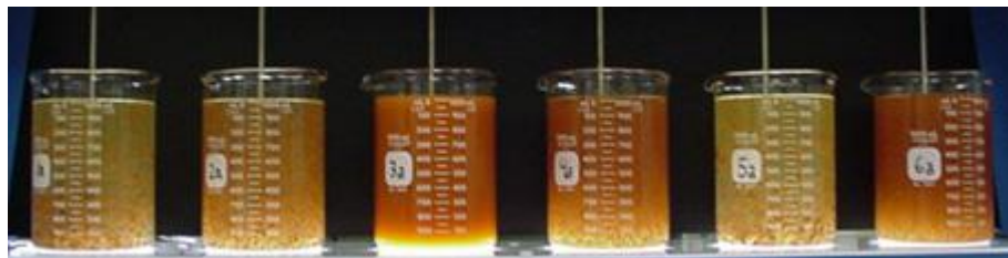
Слика 13. Процес коагулације и флокулације
