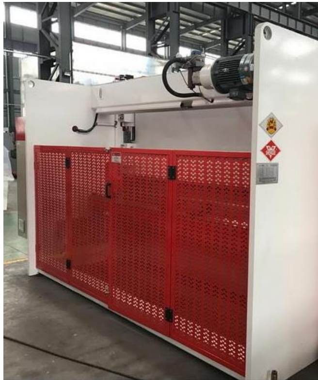
Слика 19. Заштитна врата на хидрауличној машини (обојена црвеном бојом) [11]
