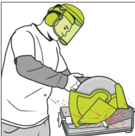
Слика 8. Излетање опилјака струготине [10]
