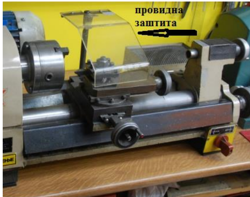
Слика 14. Покретна блокирајућа заштита на стругу [9]
