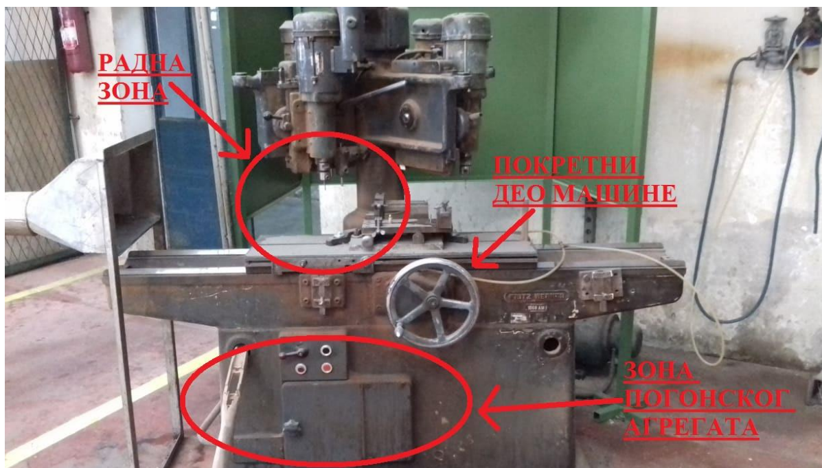
Слика 2. Хоризонтална глодалица са ознакама опасних зона [4]
