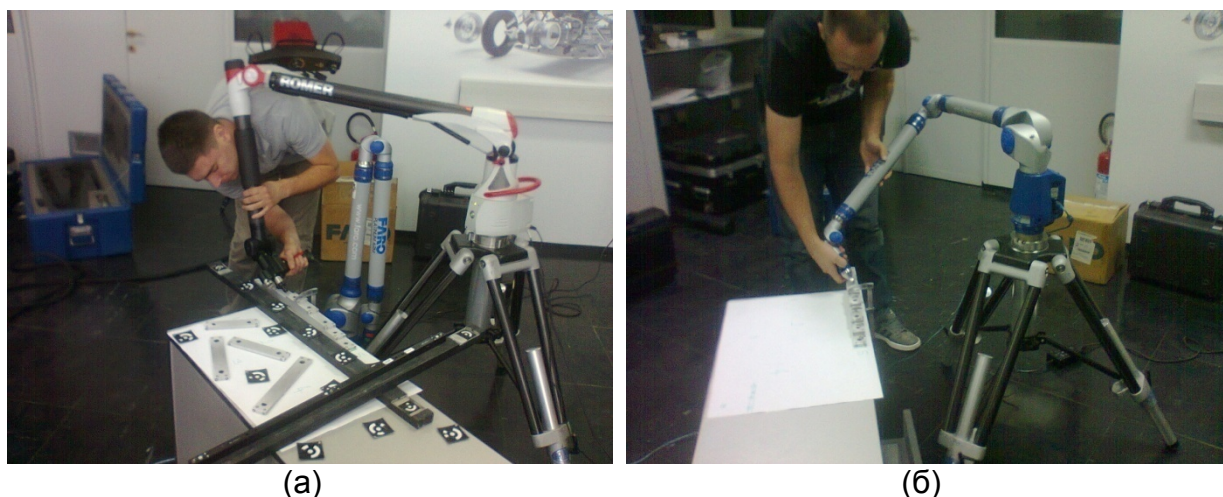
Слика 4.3.3.1. – Мерење мерним рукама: (а) ROMER Absolute Arm и(б) FARO Arm Platinum
