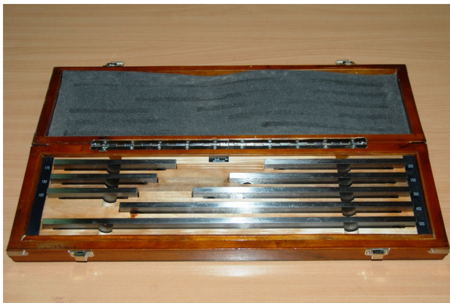
Слика 4.1.1. – Паралелна гранична мерила називних мера 100mm-500mm
