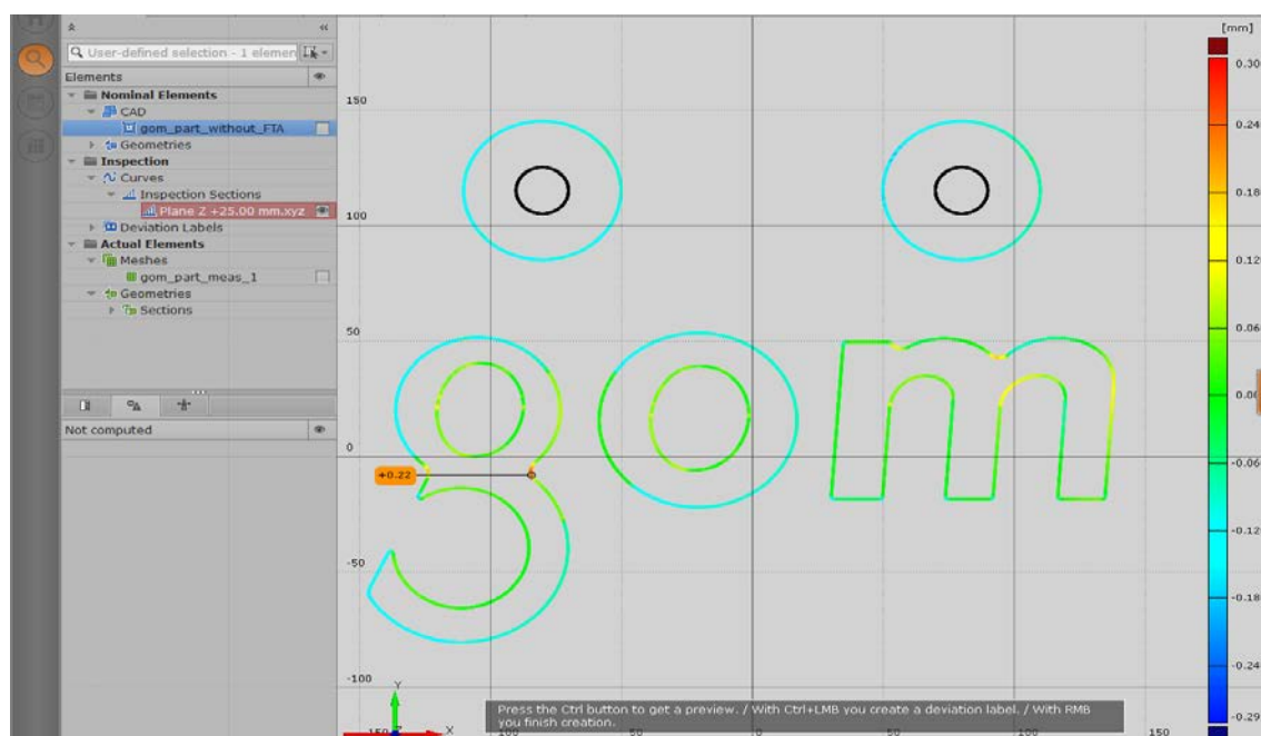
Слика 3.9.2.1. – Постављање етикета одступања (Deviation Labels) на пресек контроле (Inspection Section)
