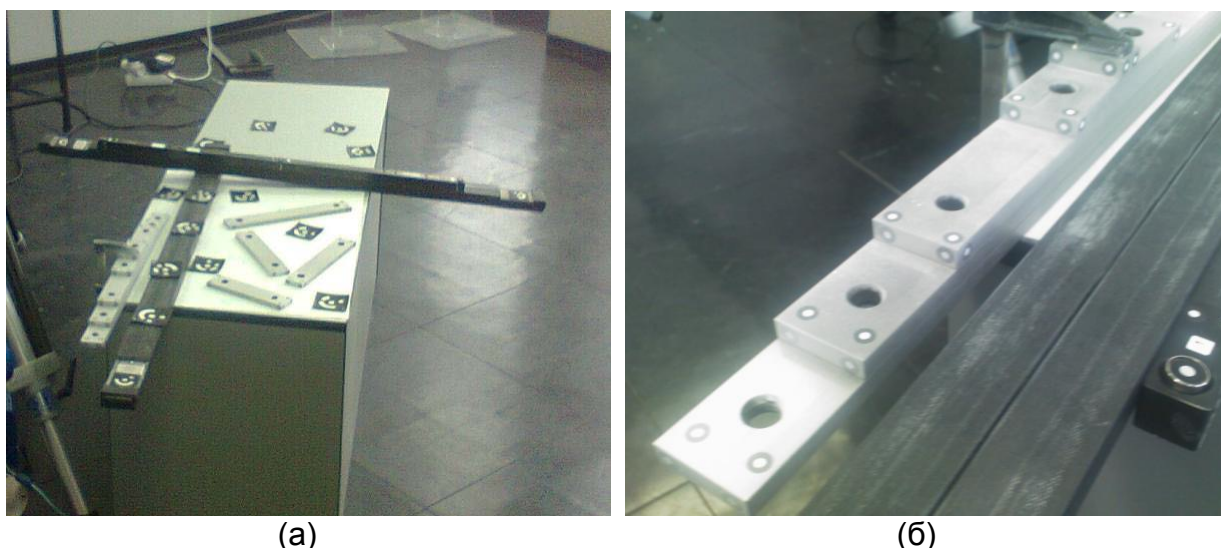
Слика 4.3.1. – Позиционирање контролних граничних мерила пре мерења и припрема мерног волумена
