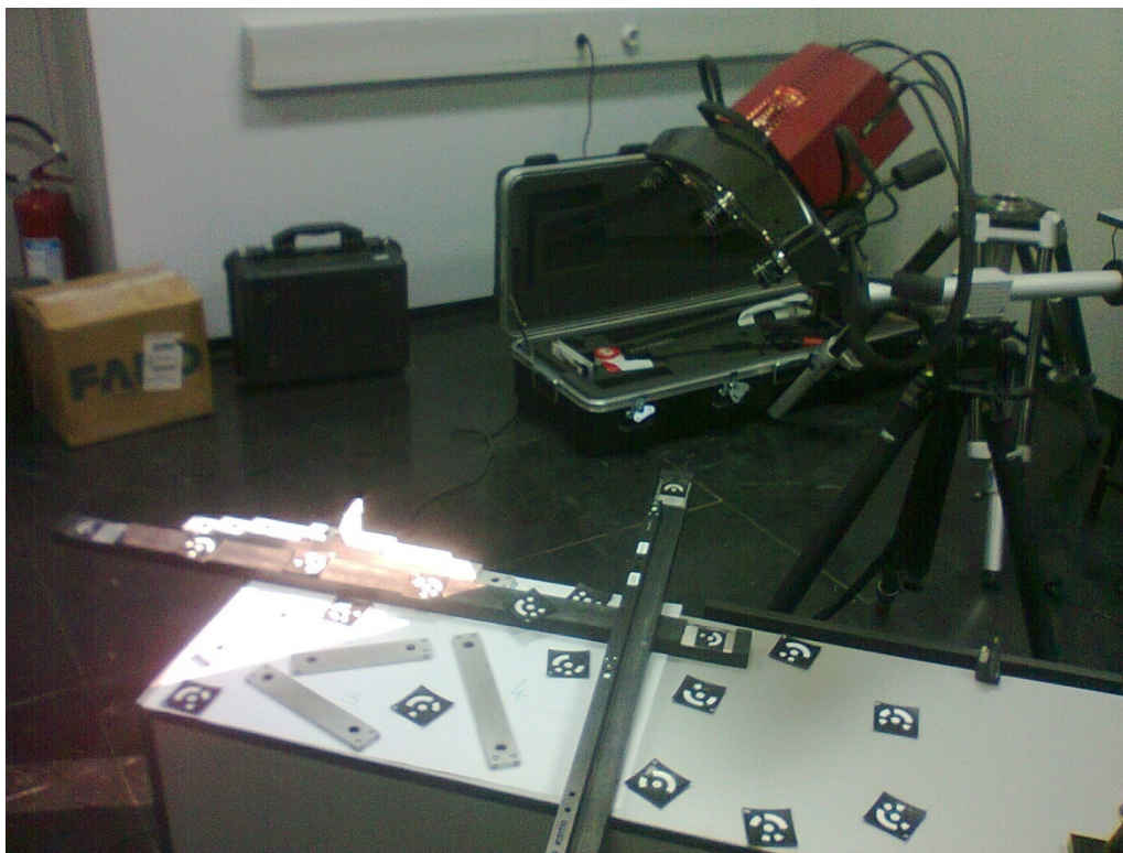
Слика 4.3.1.1. – Мерење оптичким скенером ATOS
