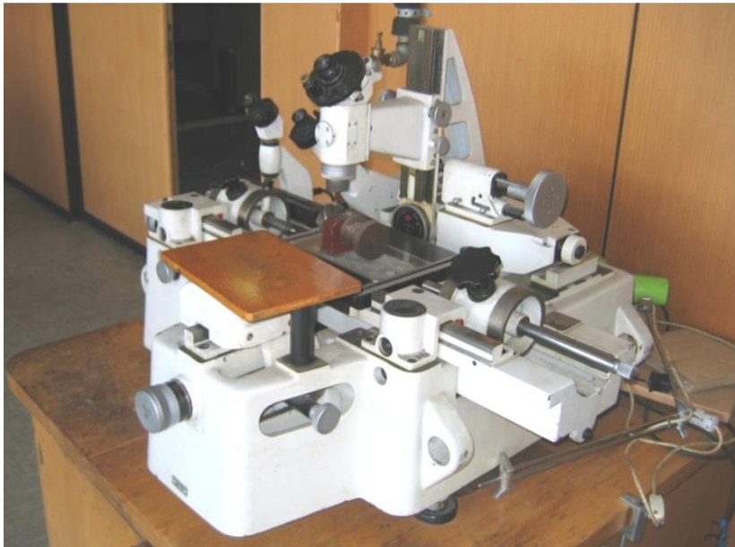
Слика 5.1. Универзални микроскоп UIM-21
