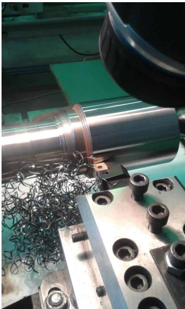
Слика 5.3. Процес обраде резањем C - плочицом
