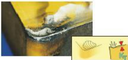
Слика 3.6. Дифузионо хабање [4]
