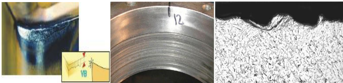
Слика 3.4. Абразивно хабање [4]
