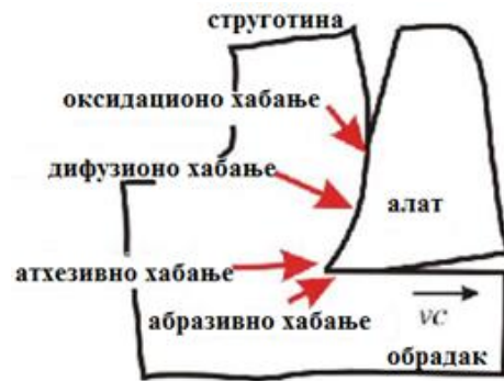
Слика 3.9. Присуство свих механизма хабања при обради резањем
