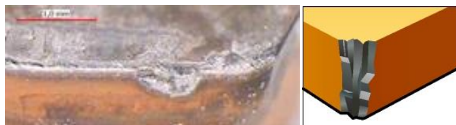
Слика 2.5. Крзање резног клина алата [4]
