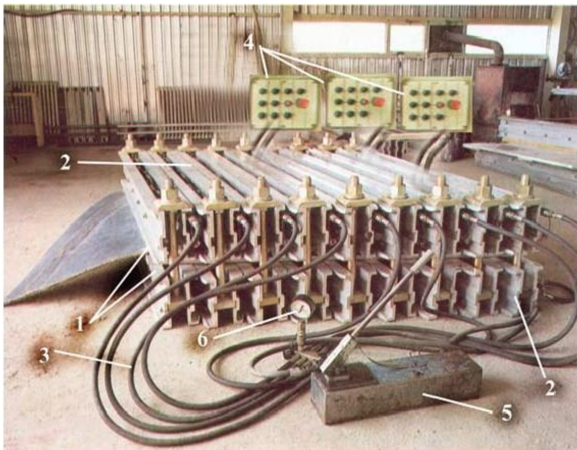
Слика 33 - Уређај за вулканизацију трака "Колубаре - метала": 1) грејне плоче; 2) хидрауличне траверзе; 3) хидраулична инсталација; 4) контролни инструменти; 5) ручна пумпа; 6) манометар [3]
