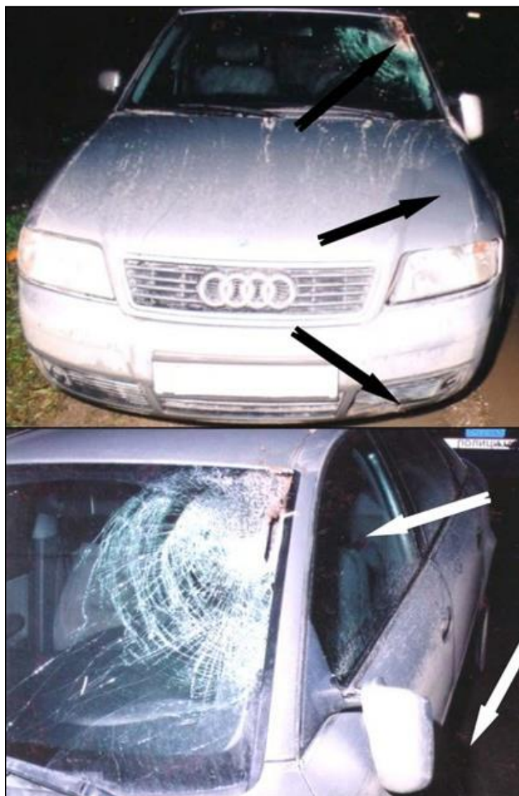
Слика 19. Оштећења на возилу приликом делимично чеоног налета у правцу возила на пешака. [7]
