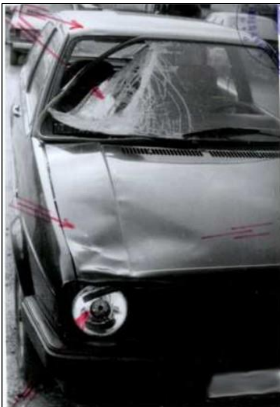
Слика 17. Оштећења на возилу приликом делимично чеоног излазног налета возила на пешака.
