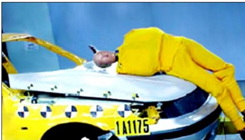
Слика 29. Испитивање ризика симулацијом налетања возил на пешака при брзини од 40 km/h.
