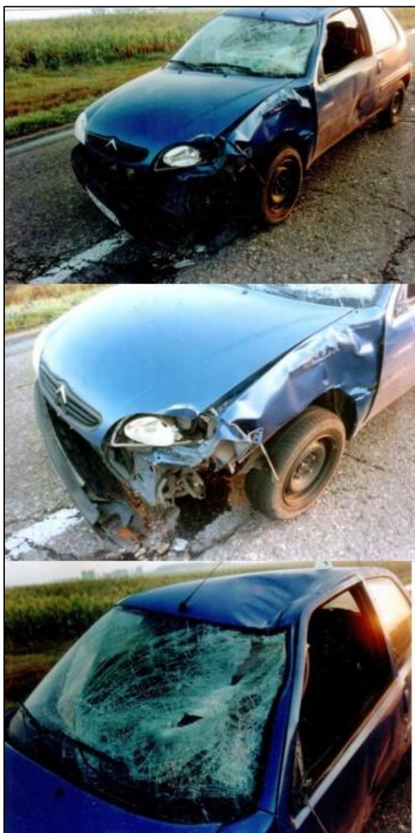
Слика 15. Оштећења на возилу приликом делимично чеоног улазног налета возила на пешака. [2]
