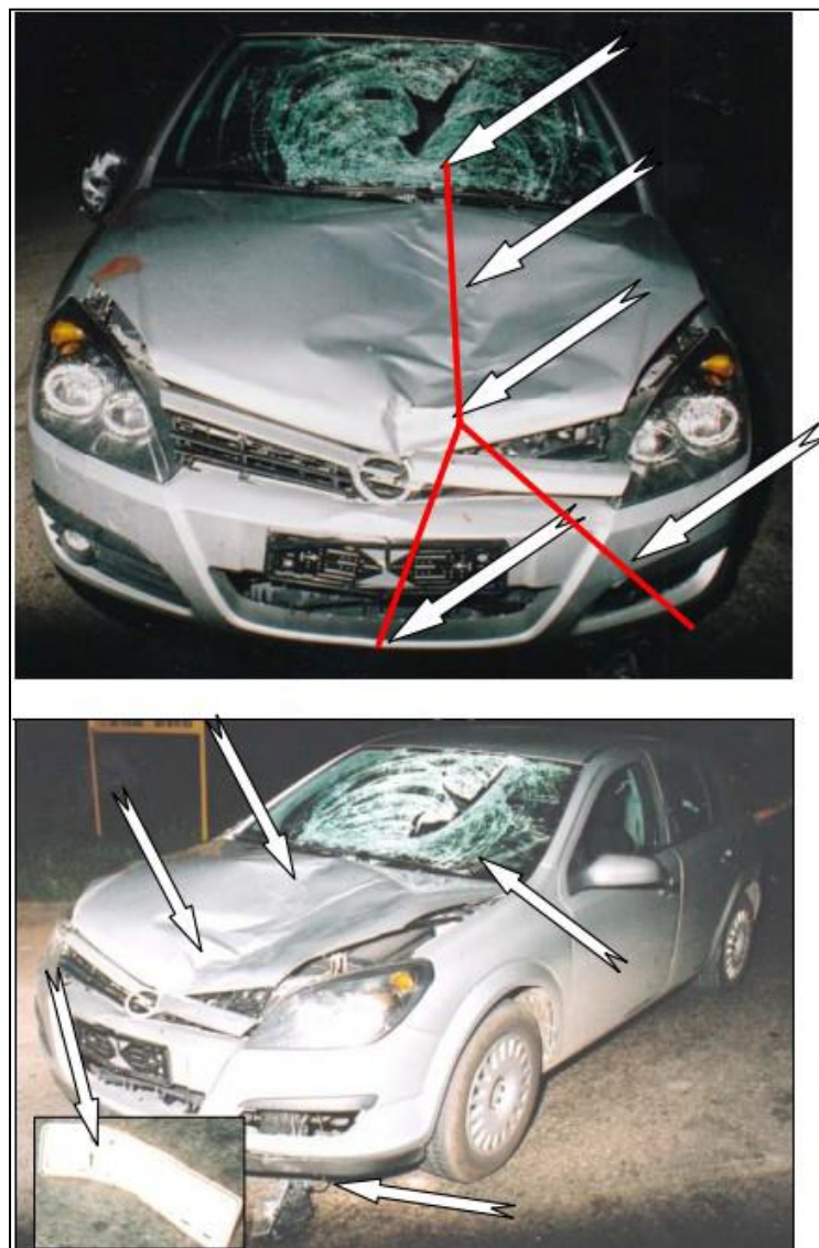
Слика 5. Оштећења на возилу приликом потпуног чеоног налета возила на пешака. [7]
