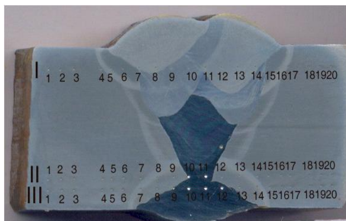
Слика 4.26. Металографски узорак - 1 за испитивање макроструктуре и мерење тврдоће
