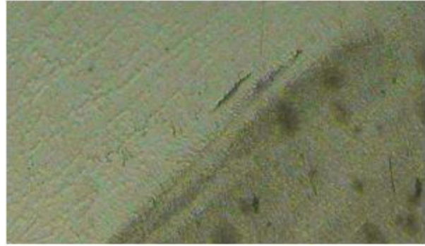
Корен МШ - аустенитно-феритна структура са финим карбидима
