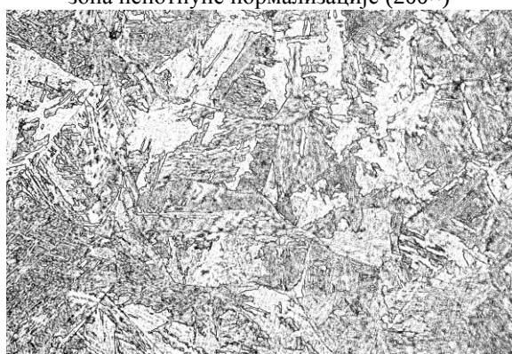
ЗУТ - крупнозрна структура, трагови бејнита, зона прегревања (200×)
