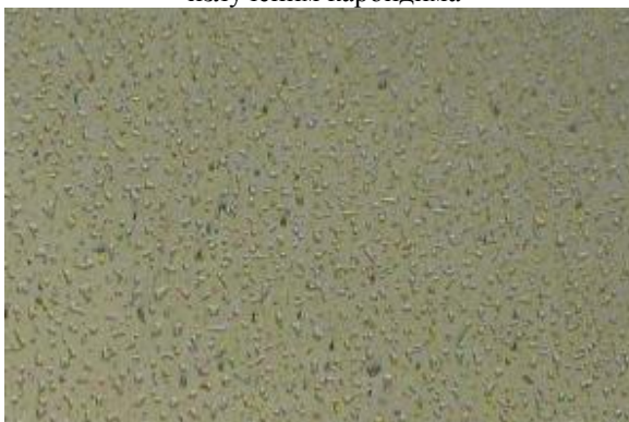
Корен МШ - аустенитно-феритна структура са излученим карбидима
