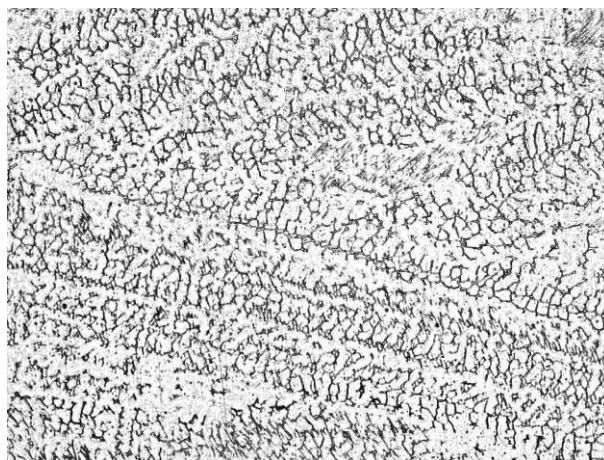
МШ - Зона стапања - аустенитна структура (200×)
