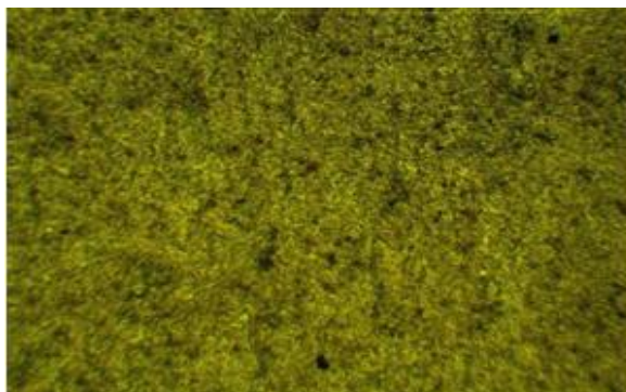
МШ - међуфазна структура - сорбит, линија I - I
