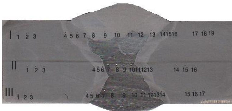
Слика 4.36. Металографски узорак за испитивање макроструктуре и мерење тврдоће
