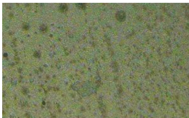
ОМ - мартензитно-бејнитна структура
