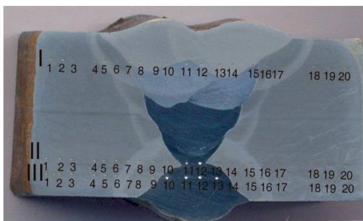
Слика 4.13. Металографски узорак - 2 за испитивање макроструктуре и мерење тврдоће сучеоно завареног споја
