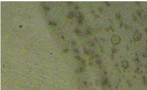
МШ - феритно-мартензитна структура са излученим карбидима
