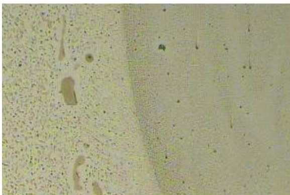
Корен МШ - аустенитно-феритна структура са финим карбидима
