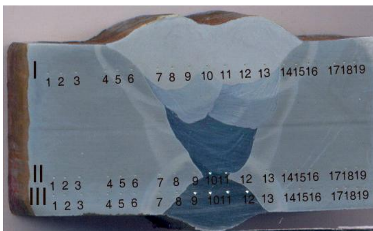
Слика 4.10. Металографски узорак - 1 за испитивање макроструктуре и мерење тврдоће сучеоно завареног споја
