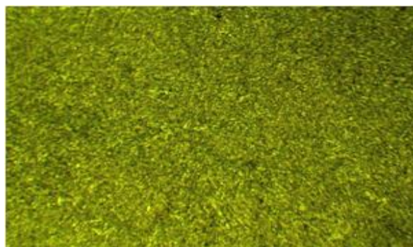
МШ - међуфазна структура, линија II - II
