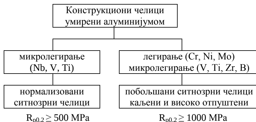
Слика 2.1. Схематски приказ развоја ситнозрних микролегираних челика
