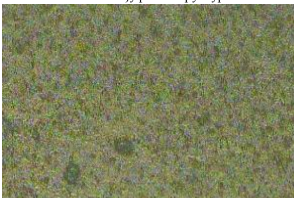
МШ - феритно-мартензитна структура са излученим карбидима
