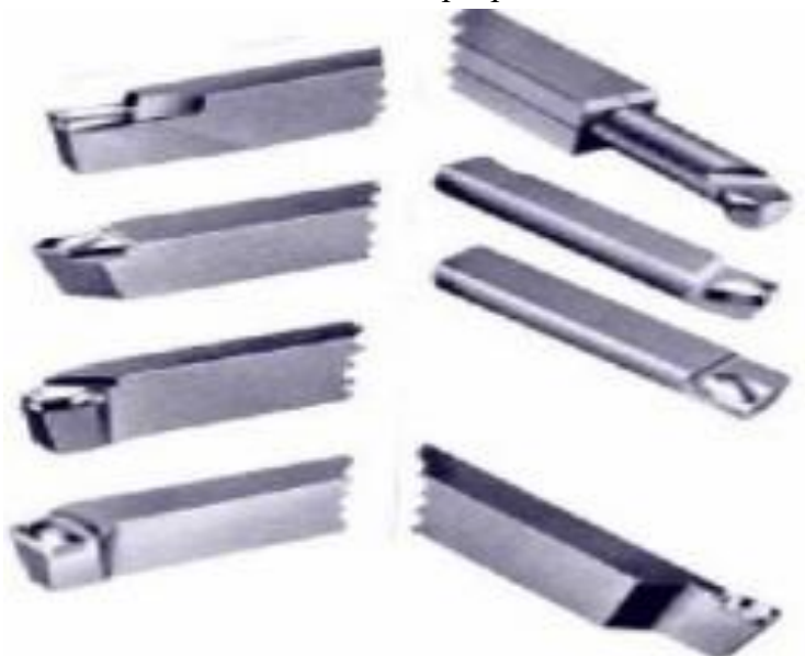
Слика 2.4.5 Стругарски ножеви са лемљеним плочицама од тврдог метала [5]
