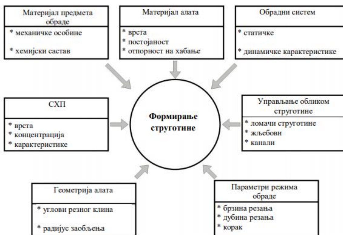
Слика 3.1 Утицајни фактори на процес формирања струготине [4]
