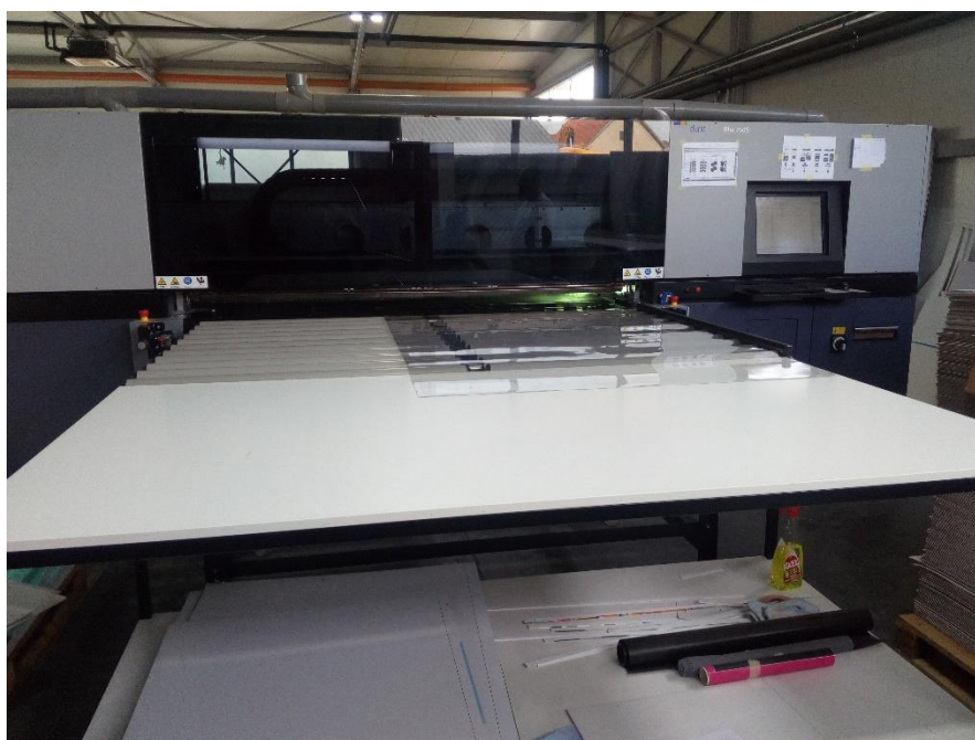
Слика 5. CNC машина за сечење плочастог материјала (Произвођач : IECHO Science Technology Co.Ltd, Yhejiang Province, China)
