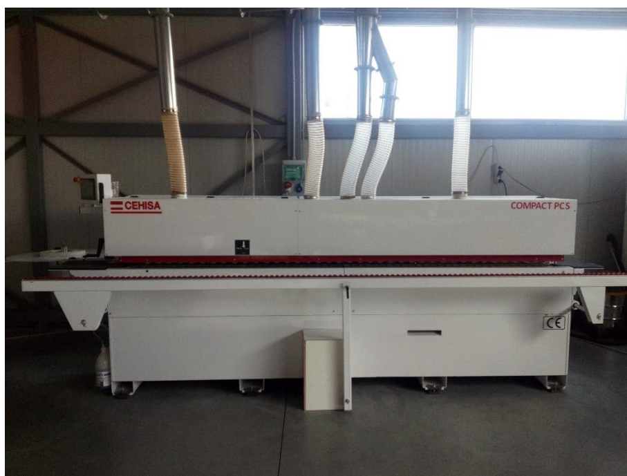
Слика 7. Кантерица (Произвођач CEHISA, Caldes de Montbul, SPAIN)
