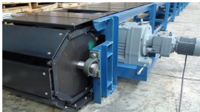
Слика 1.2. Плочасти транспортер за комадне терете компаније Adept [4]
