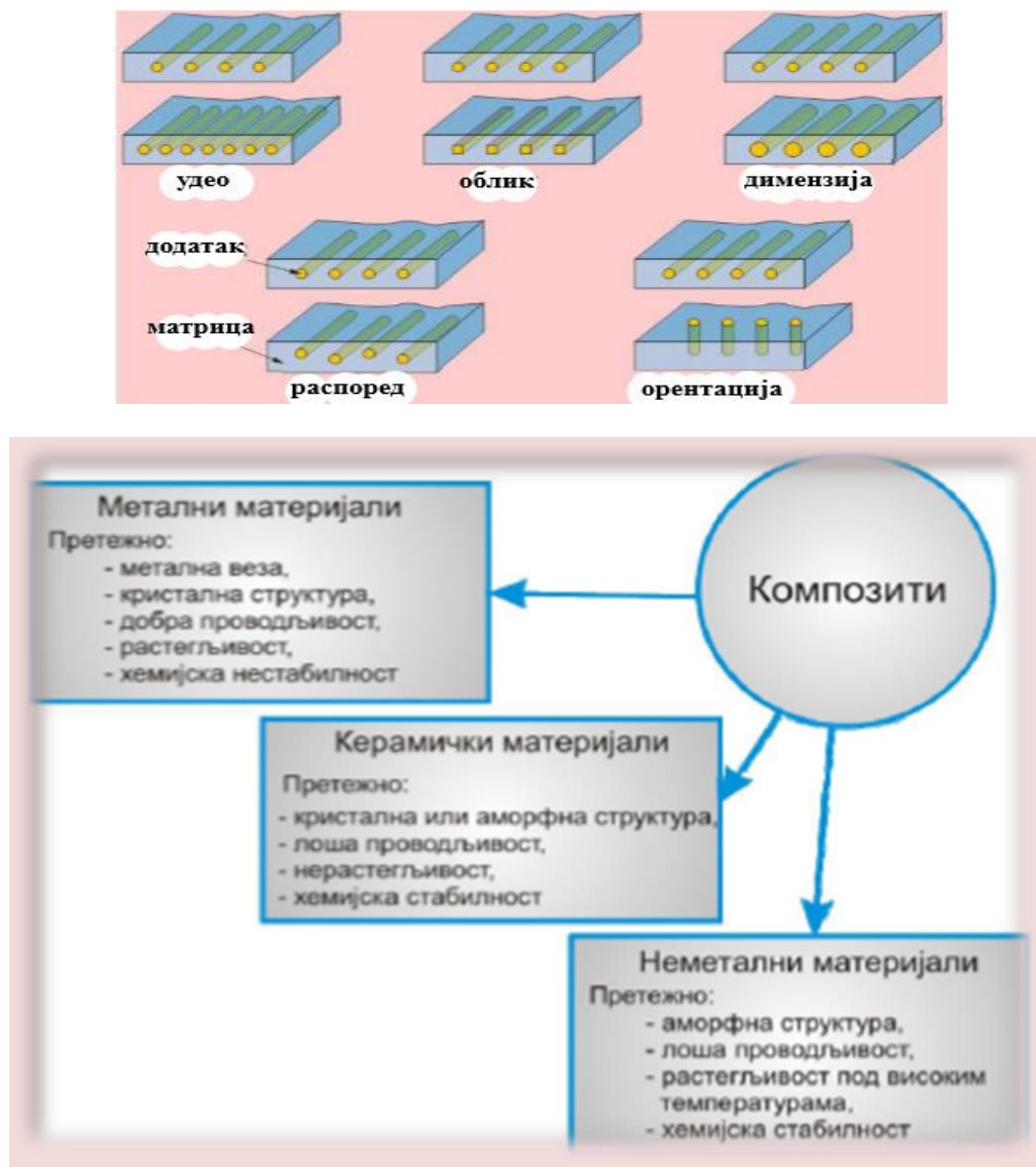
Слика 5.8. Структура влакна и специфичности композитних материјала [34]
