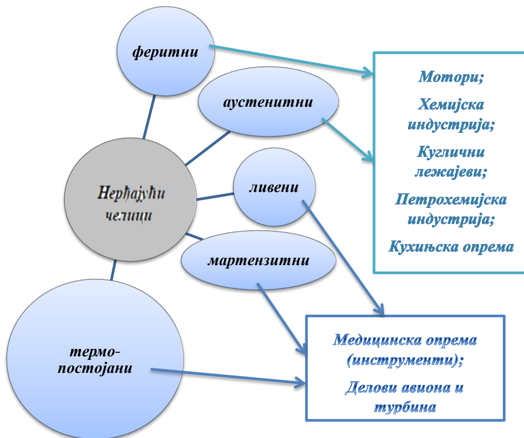
Слика 5.5. Шема употребе нерђајућих челика према подели металуршке структуре [29]
