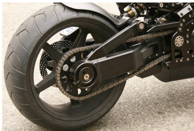
Слика 57 – Основи делови механизма ланчаног пара (ланац – ланчаник)
