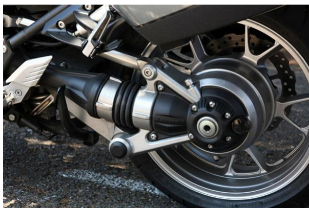
Слика 62 – Мотоцикли који користе вратило – зупчаник за пренос снаге
