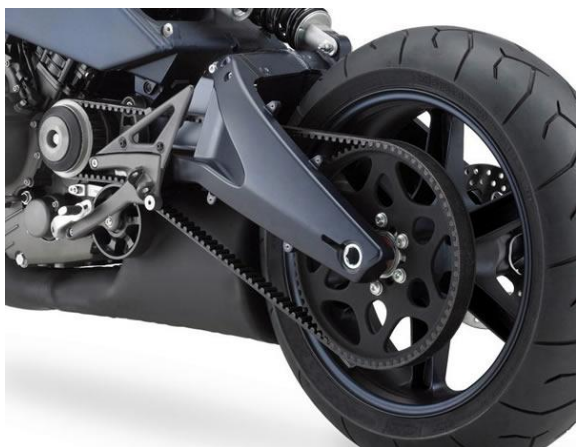
Слика 60 – Мотоцикли који користе гумени зупчасти ремен као преносник снаге
