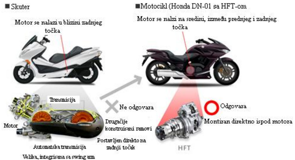
Слика 64 – Конструктивна извођења аутоматске трансмисије и HFT - а
