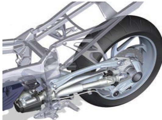
Слика 30 – Пренос снаге системом вратило-зупчаник
