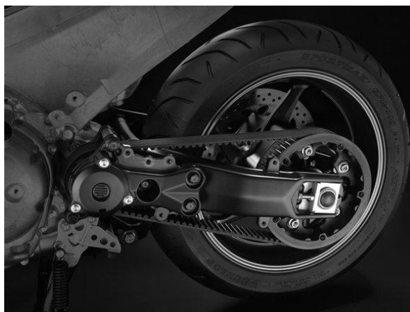
Слика 60 – Мотоцикли који користе гумени зупчасти ремен као преносник снаге
