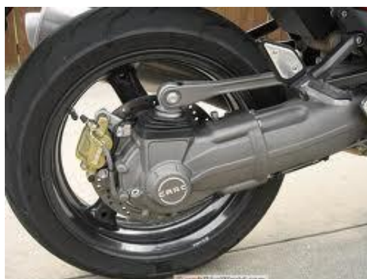
Слика 62 – Мотоцикли који користе вратило – зупчаник за пренос снаге
