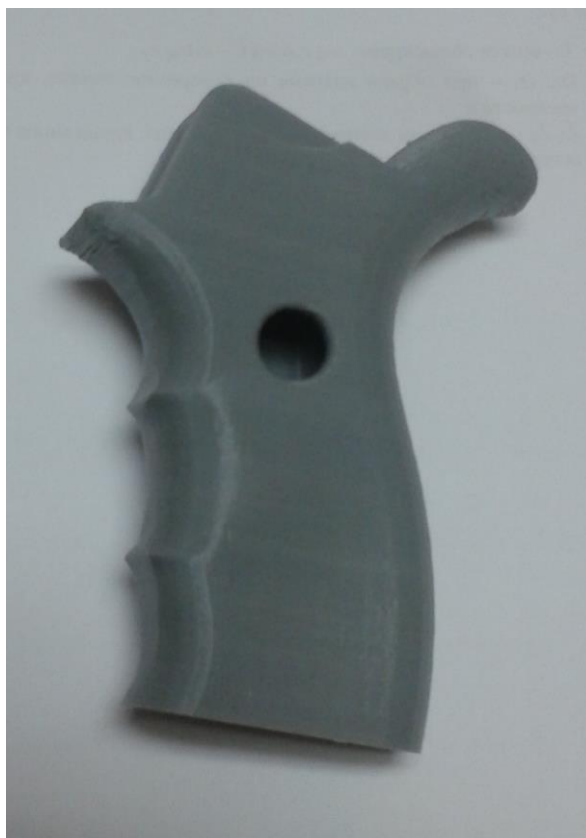
Слика 34. Рукохват штампан на 3D штампачу
