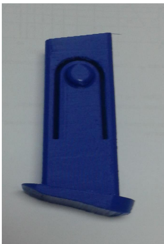
Слика 35. Шаржер штампан на 3D штампачу
