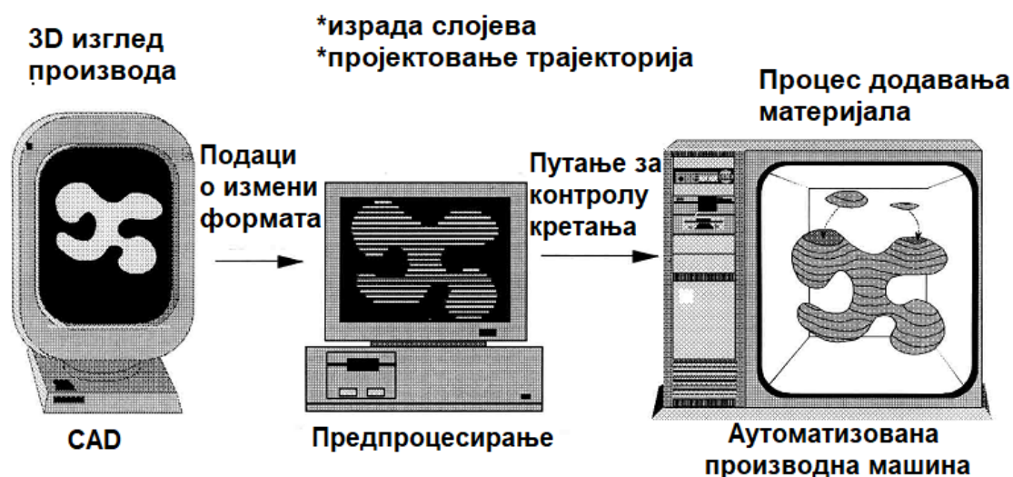
Слика 2. СФФ производња заснована на парадигми израде путем слојева
