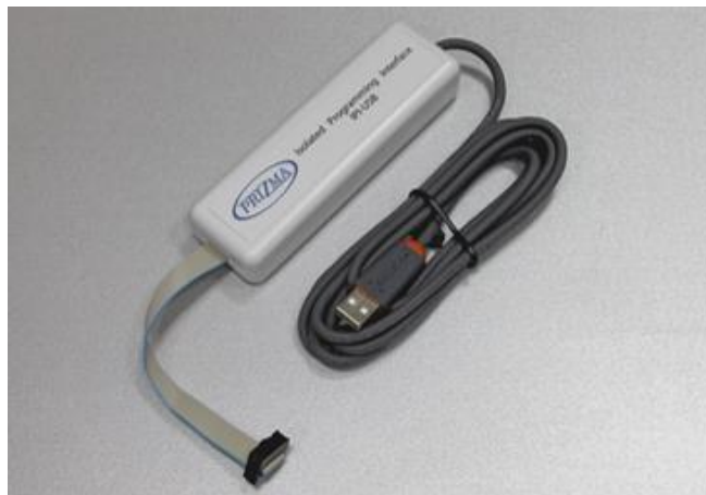
Слика 12. Изолациони интерфејс за програмирање IPI-USB [10]
