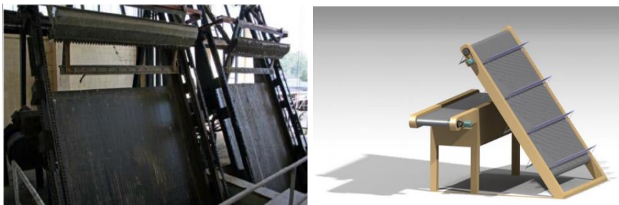
Слика 18. Механичко пречишћавање – Решетке [23]
