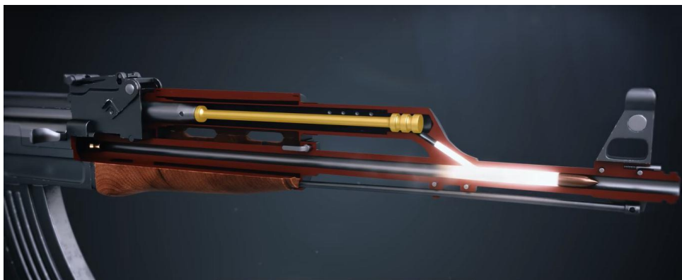
Слика 10. Позајмица барутних гасова делује на гасни клип [10]
