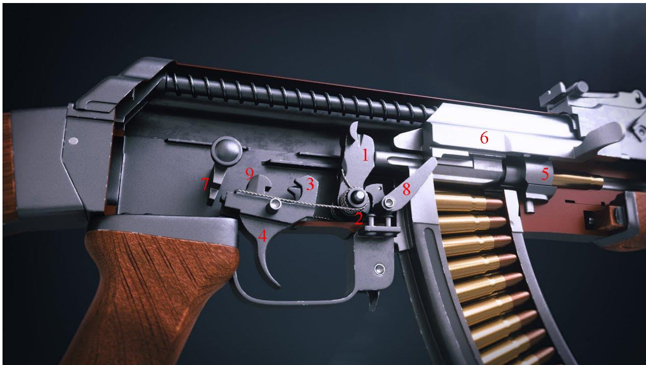
Слика 11. Делови механизма окидања и забрављивања код Калашњикова: 1. Ударач; 2. Опруга удараца; 3. Запињача; 4. Обарача; 5. Затварач; 6. Носач затварача; 7. Регулатор паљбе; 8. Осигурач превременог опаљења; 9. Раздвајач паљбе [11]
