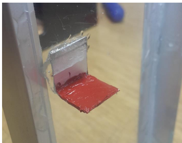
Слика 20. Носач плоче залепљен на страницу кућишта
